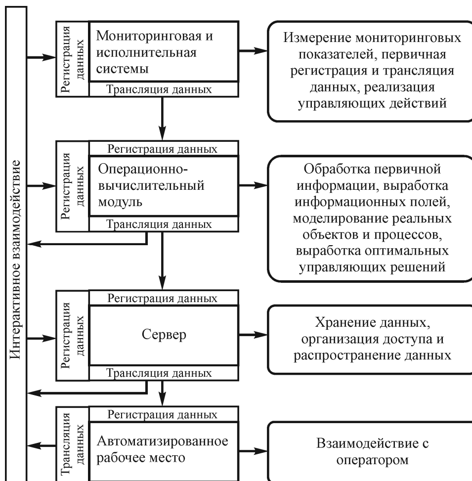
Рисунок 1 – Информационная система мониторинга и управления орошением с серверной схемой организации обмена информацией
