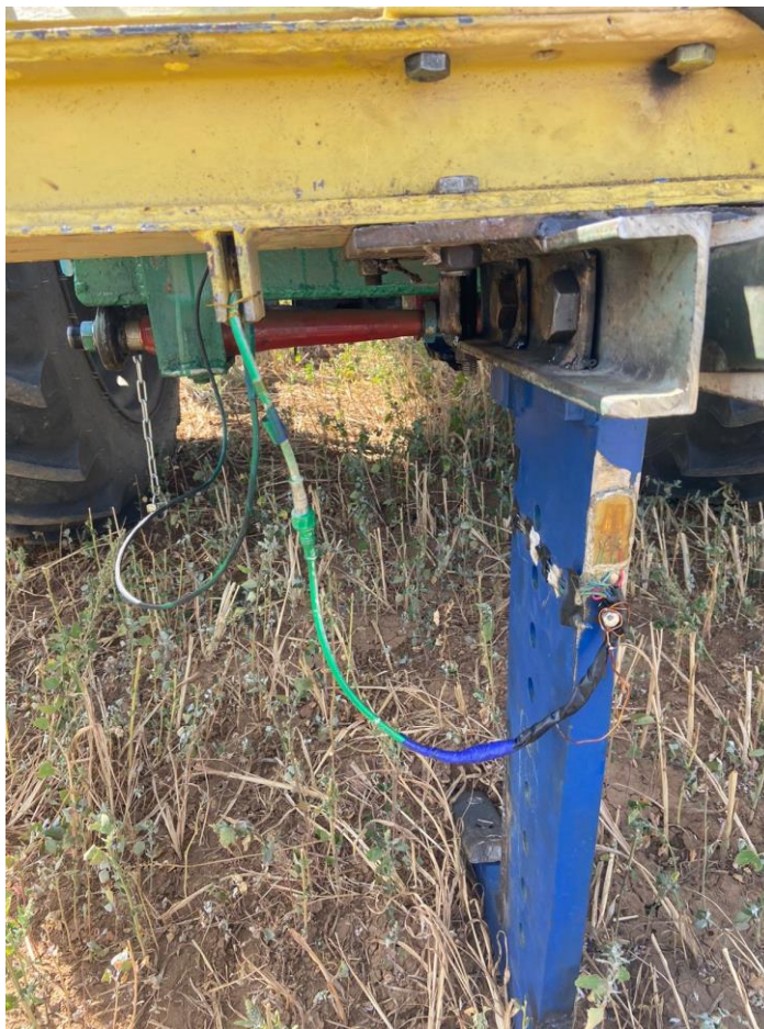
Рисунок 3.9 – Измерение горизонтальной составляющей тягового сопротивления чизельной стойки
