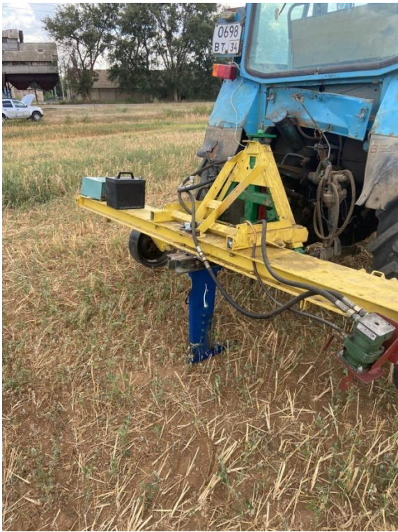
Рисунок 3.3 – Общий вид экспериментальной установки по определению тягового сопротивления рабочей секции чизельного орудия
