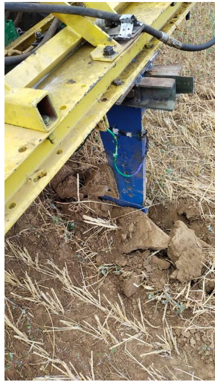
Рисунок 3.3 – Общий вид экспериментальной установки по определению тягового сопротивления рабочей секции чизельного орудия
