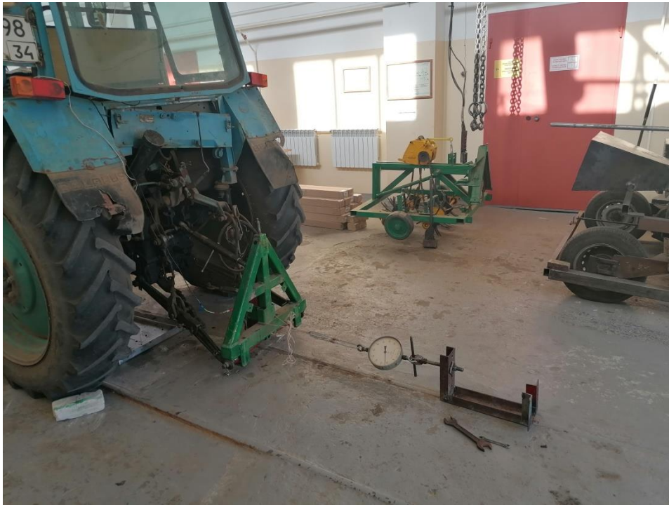
Рисунок 3.7 – Тарирование устройства для измерения горизонтального усилия от сельскохозяйственной машины, навешиваемой на трактор
