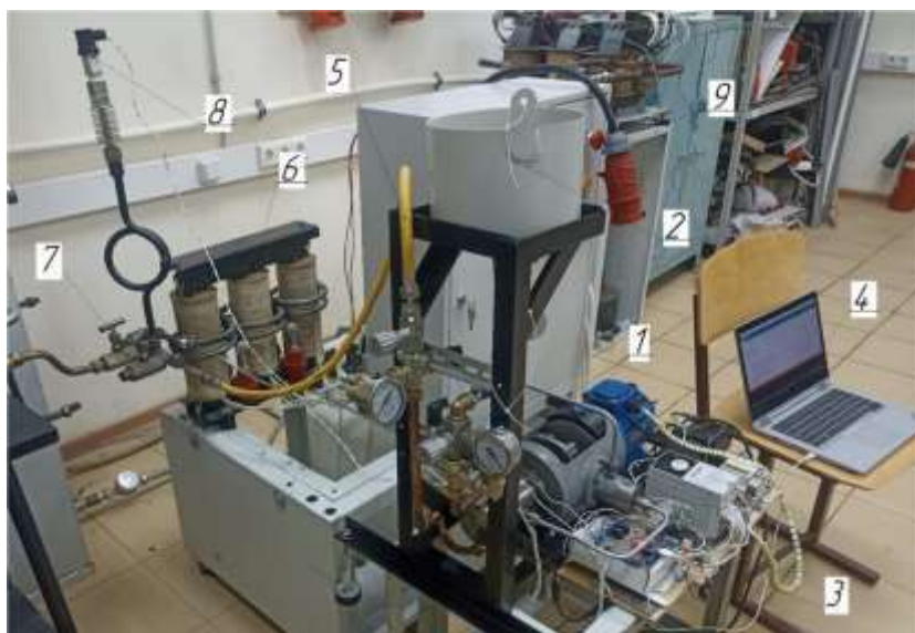
Рисунок 4 – Испытательный стенд насоса подачи воды пароплазменной жидкотопливной горелки. 1 – радиально-плунжерный насос подачи воды, 2 – бак с водой, 3 – система управления насосом подачи воды, 4 – ноутбук, 5 – трубопровод подачи воды, 6 – пароплазменный генератор, 7 – дроссель, 8 – датчика давления пара, 9 – система управления пароплазменным генератором Figure 4 – A test bench of a steam plasma liquid fuel burner water supply pump. 1 – radial plunger water supply pump, 2 – water tank, 3 – water supply pump control system, 4 – laptop, 5 – water supply pipeline, 6 – steam plasma generator, 7 – restriction, 8 – steam pressure sensor, 9 – steam plasma generator control system
