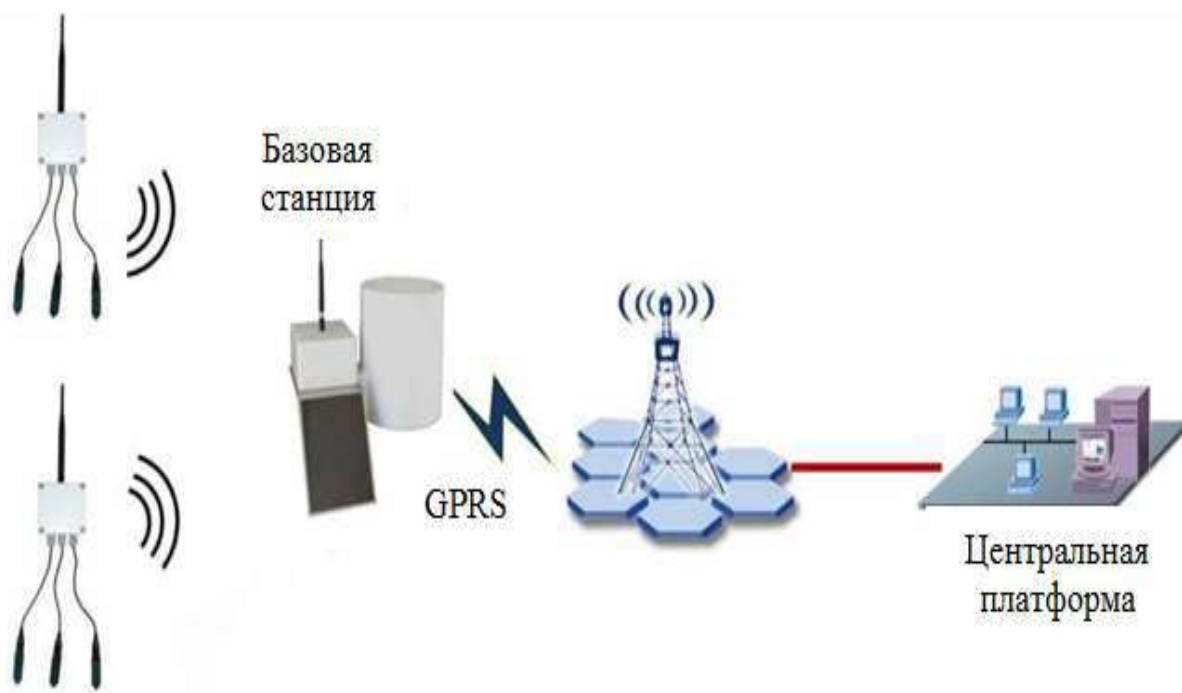
Рисунок 1 – Схема передачи данных мониторинга почв с использованием полевых датчиков Figure 1 – Schematic diagram of soil monitoring data transmission using field sensors
