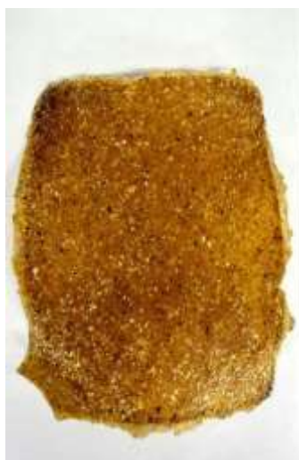
Рисунок 4 – Образец 3 с содержанием кукурузной мезги в количестве 10,6 %, пектина – 3,00 %, глицерина – 2,2 % и формовки методом горячего прессования Figure 4 – Sample 3 with a composition of 10.6 % corn bran, 3,00 % pectin, 2,20 % glycerol, molded using the hot pressing method
