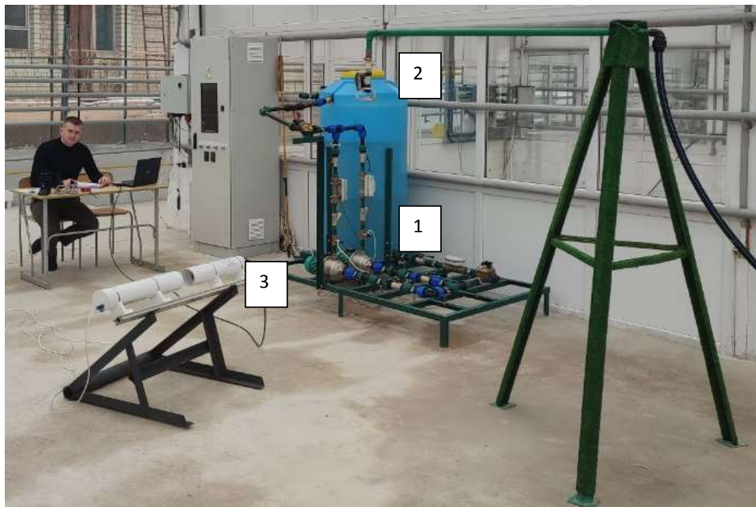
Рисунок 3 – Общий вид лабораторного стенда исследования дождеобразующих устройств 1 – стенд регулирования давления на насадке; 2 – испытуемое дождеобразующее устройство; 3 – голографический дисдрометр Figure 3 – General view of the laboratory stand for testing rain-generating devices 1 – nozzle pressure regulation stand; 2 – test rain-generating device; 3 – holographic disdrometer
