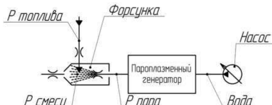
Рисунок 1 – Схема организации потоков в форсунке пароплазменной горелке Figure 1 – Flow pattern in a steam-plasma burner nozzle
