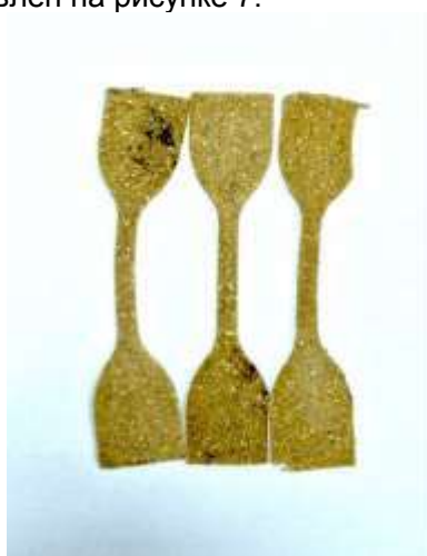
Рисунок 6 – Образец 4 с содержанием кукурузной мезги в количестве 10,52 %, пектина – 2,98 %, глицерина – 2,19 %, кальция – 1,05 % и формовки методом горячего прессования Figure 6 – Sample 4 with a composition of 10.52 % corn bran, 2.98 % pectin, 2.19 % glycerol, 1.05 % calcium, molded using the hot pressing method
