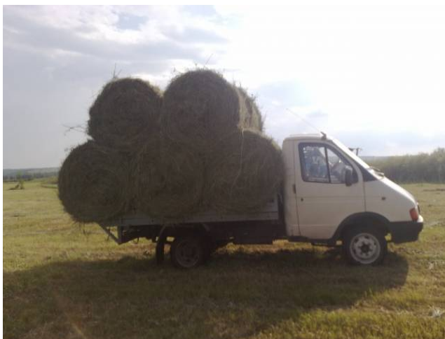
Рисунок 1 – Транспортировка рулонов сена на автомобиле ГАЗ- 3302 со специальной грузовой платформой
