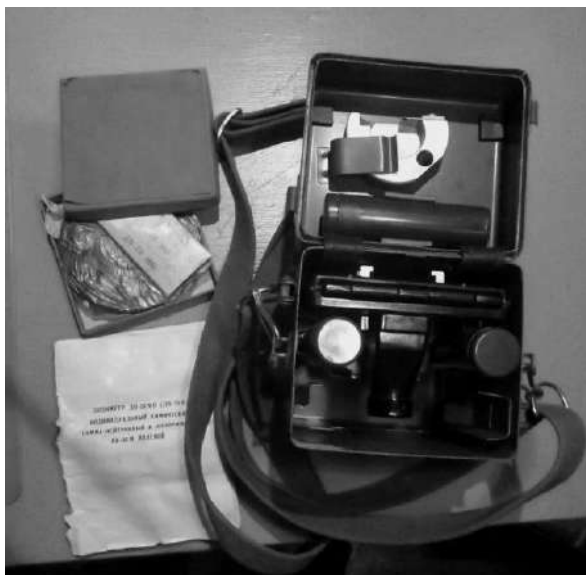
Рисунок 13 - Химический дозиметр ДП-70МП
