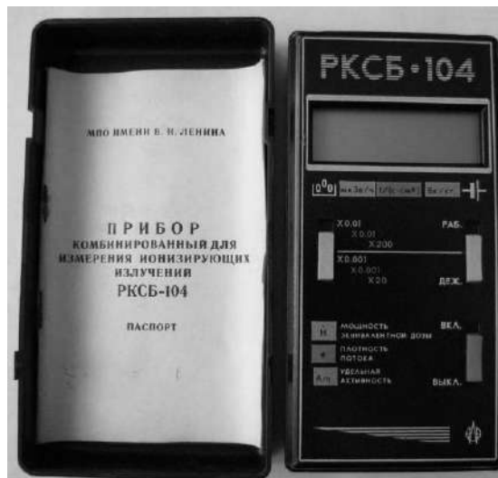
Рисунок 15 - Бытовой дозиметр РКСБ-104
