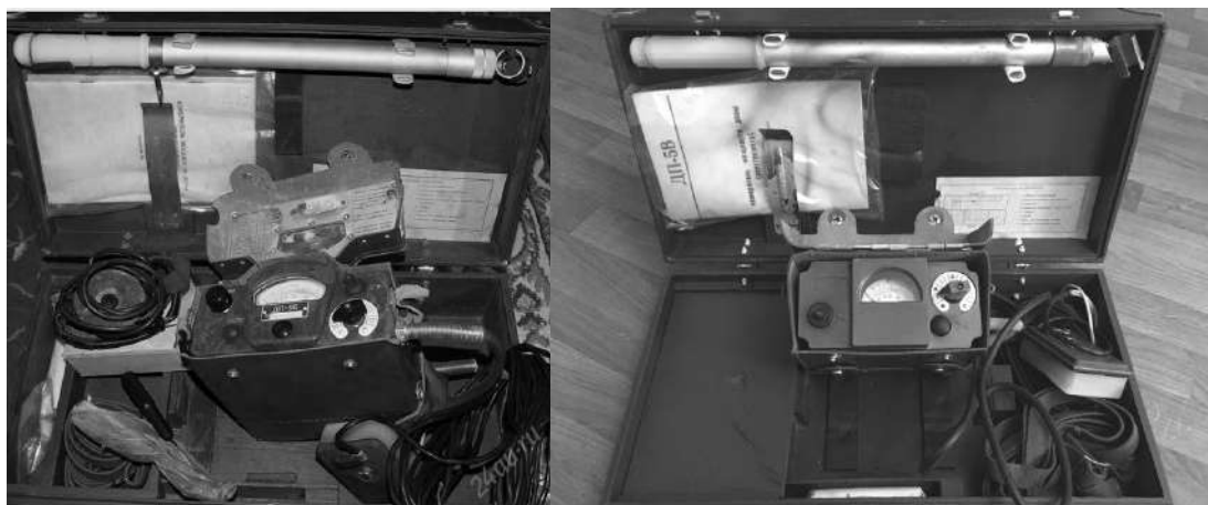
Рисунок 9 - Прибор ДП-5Б, 5В.
