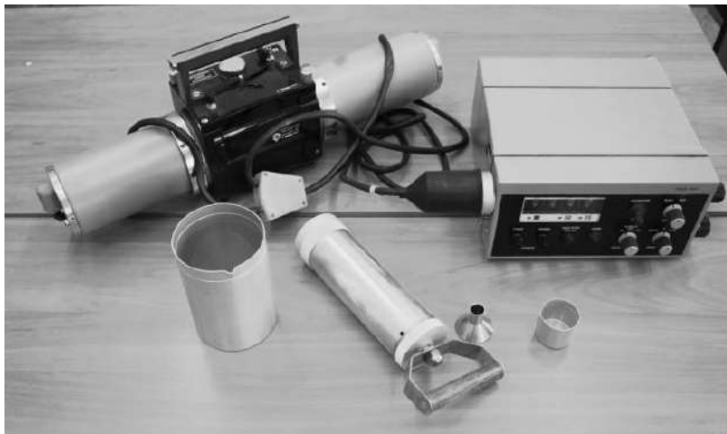
Рисунок 4 – Радиометр контроля бета – излучения РКБ4-М
