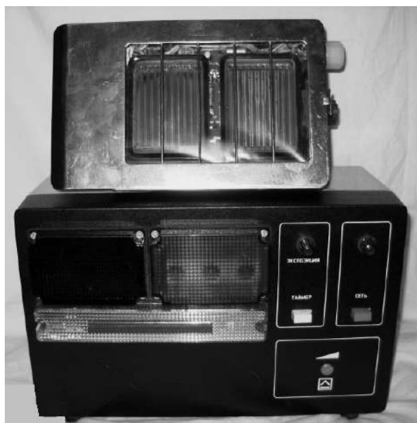
Рисунок 5 – Сигнализатор загрязненности СЗБ-04
