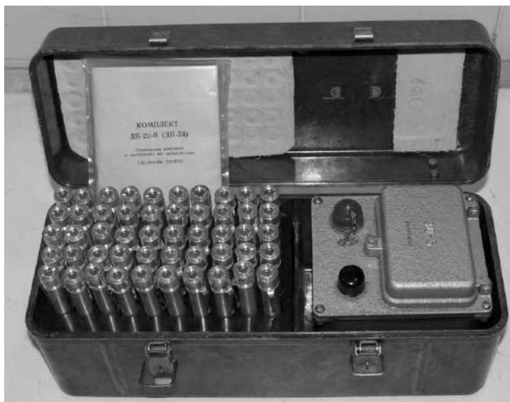
Рисунок 10 - Комплект дозиметров ДП-22В
