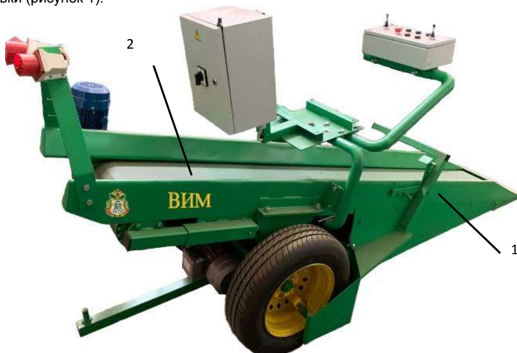
1 – подборщик автоматизированный; 2 – система транспортеров
