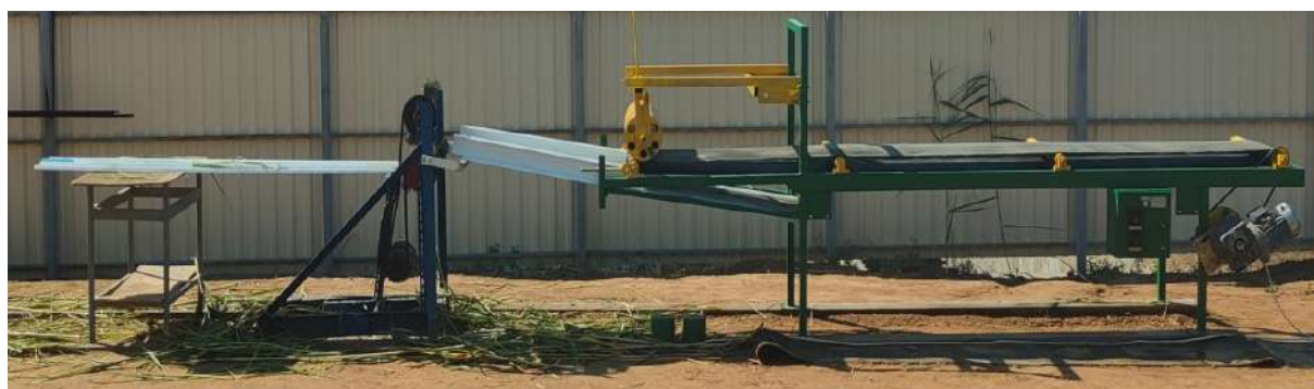
Рисунок 2 – Экспериментальная установка устройства подачи тростника южного на очес метелок Figure 2 – Experimental installation of a southern reed feeding device for broomsticks
