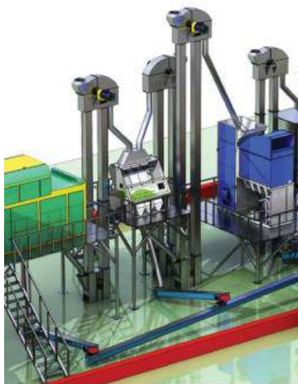
Рисунок 3 – Размещение оптического сортировщика в технологической линии переработки зерна (источник https://agro-centre.ru/ )
