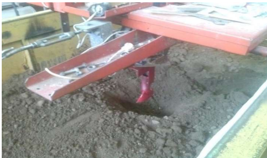
Рисунок 1 – Исследования модели укладчика капельной ленты в грунтовом канале
