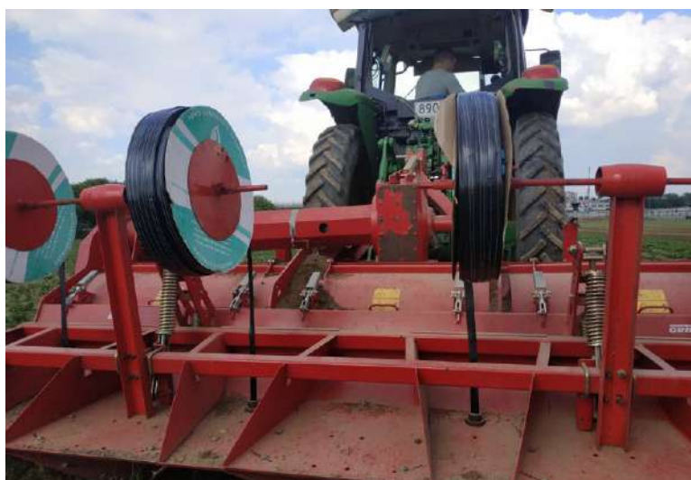
Рисунок 4 – Испытания укладчика капельной ленты на базе формирователя гребней Figure 4 – Testing of a drip tape stacker based on a comb shaper
