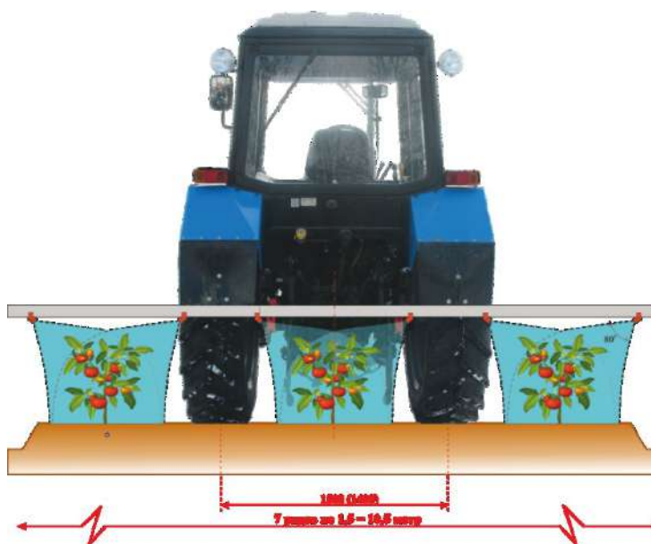
Рисунок 3 – Технологический процесс полосового опрыскивания Figure 3 – Technological process of strip spraying
