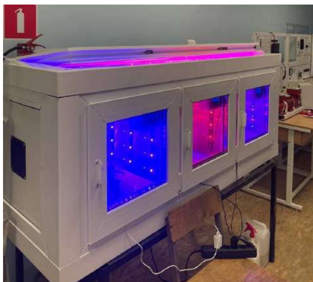
Рисунок 1 – Энергосберегающий модульный фитотрон Figure 1 – Energy-saving modular phytotron
