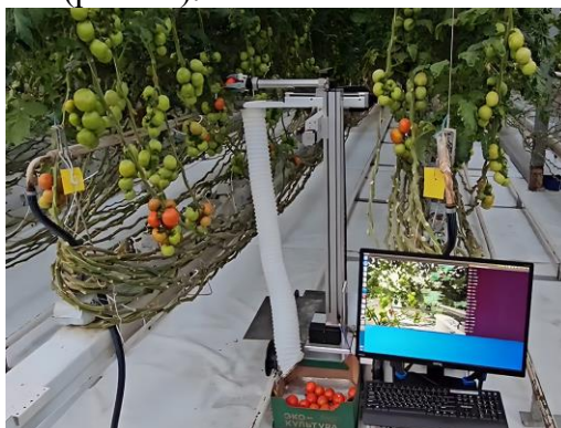
Рис. 42. Робот перемещается вдоль томатов по специальным направляющим
