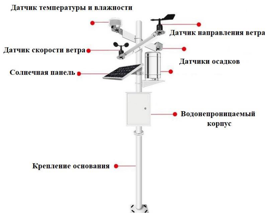
Рис. 49. Устройство автоматической метеостанции
