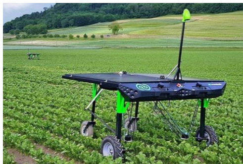
Рис. 43. Ecorobotix — автономный робот для прополки рядовых культур
