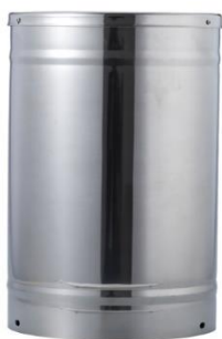
Рис. 54. Дождемер с опрокидывающимся ведром
