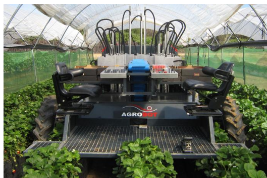
Рис. 31 Робот: Agrobot SW6010 и AGSHydro, гидропонная система выращивания и сбора урожая клубники.
