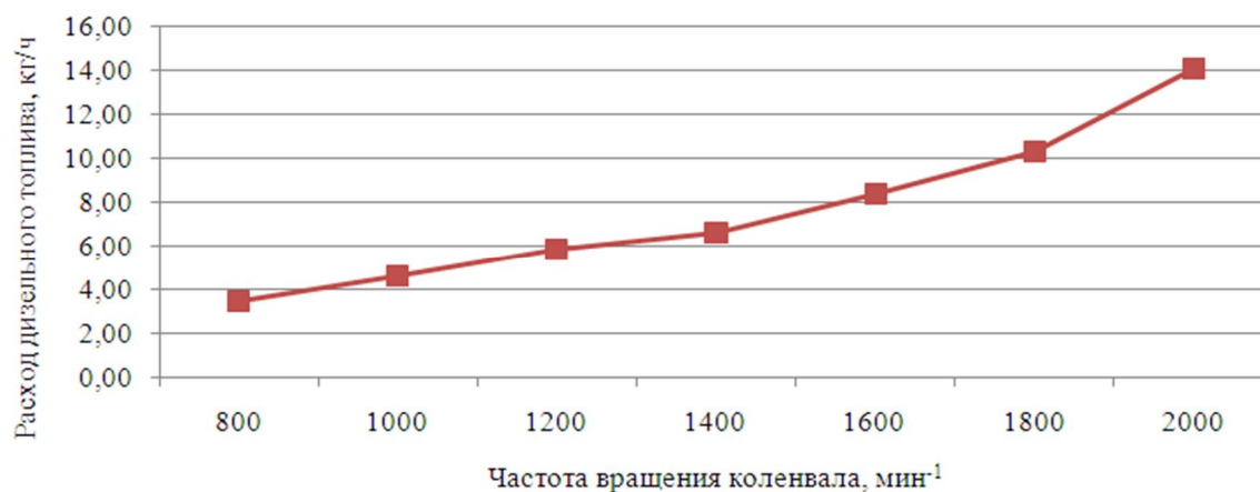
Рисунок 2 – Результаты испытаний двигателя ЯМЗ-238НД5 при работе по дизельному циклу на холостом ходу
