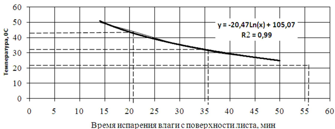
Рисунок 2 – График зависимости времени испарения влаги с поверхности площади листьев от температуры воздуха
