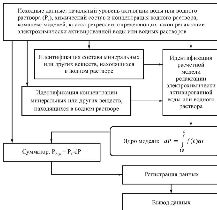
Рисунок 3 – Модель релаксации электрохимически активированной воды и водных растворов минеральных удобрений
