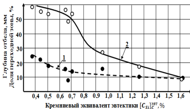
Рисунок 4 – Зависимость глубины полного отбела (кривая 1) и доли переходной зоны в общей толщине отбеленного слоя (кривая 2) от кремниевого эквивалента эвтектики
