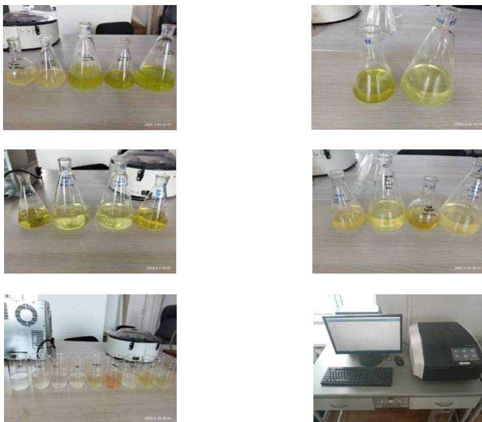
Рисунок 1 – Получение эталонов экстрактов из пророщенного зерна, методом спиртовой экстракции Figure 1 – Obtaining standards of extracts from sprouted grain by alcohol extraction
