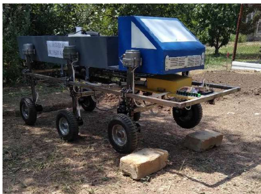
Рисунок 13 – Исследование преодоления препятствия экспериментальным транспортным средством способом шагания
