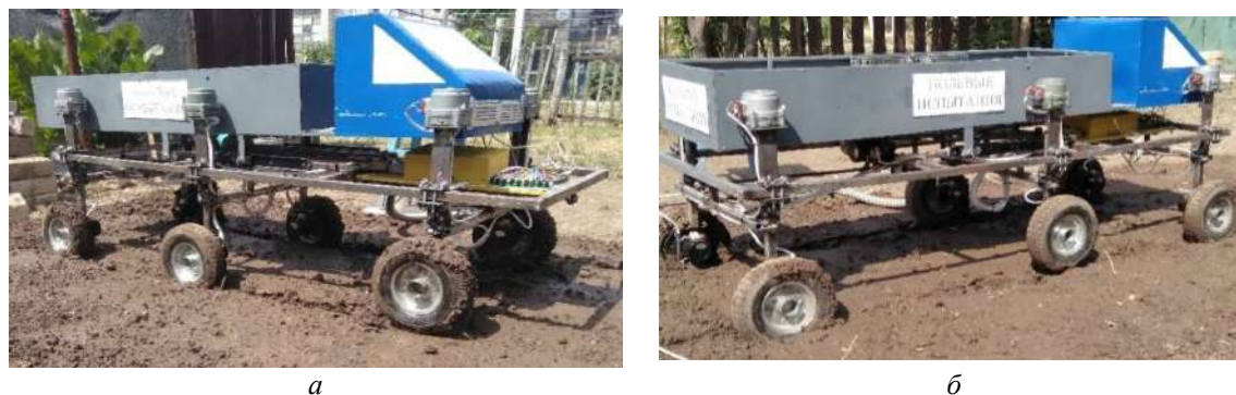
Рисунок 10 – Фрагменты передвижения способом шагания экспериментального транспортного средства по основанию «влажный вспаханный грунт»
