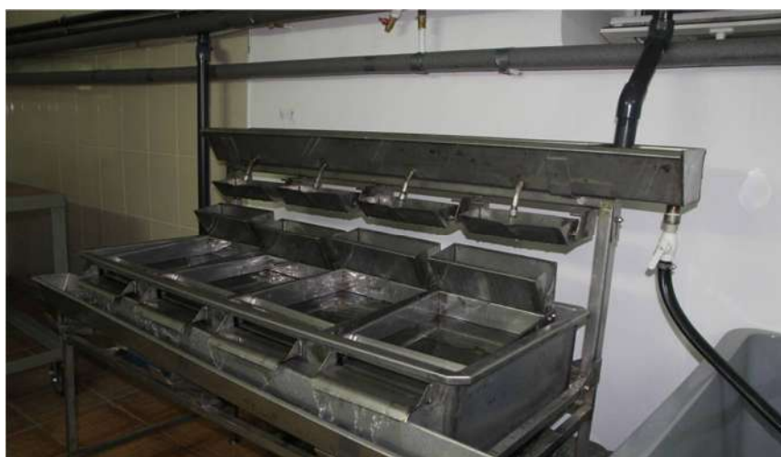
Рисунок 3 – Инкубационный аппарат «Осетр» Figure 3 – Incubation apparatus "Sturgeon"
