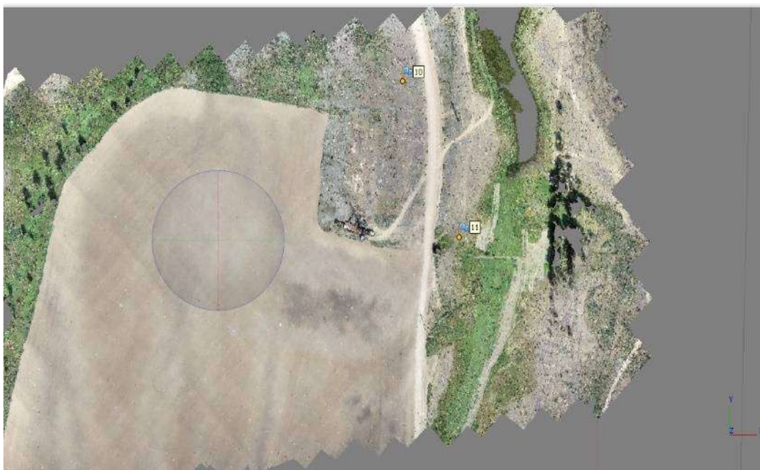
Рисунок 2 – Сформированный в Agisoft Metashape на основе данных с БПЛА фотоплан
