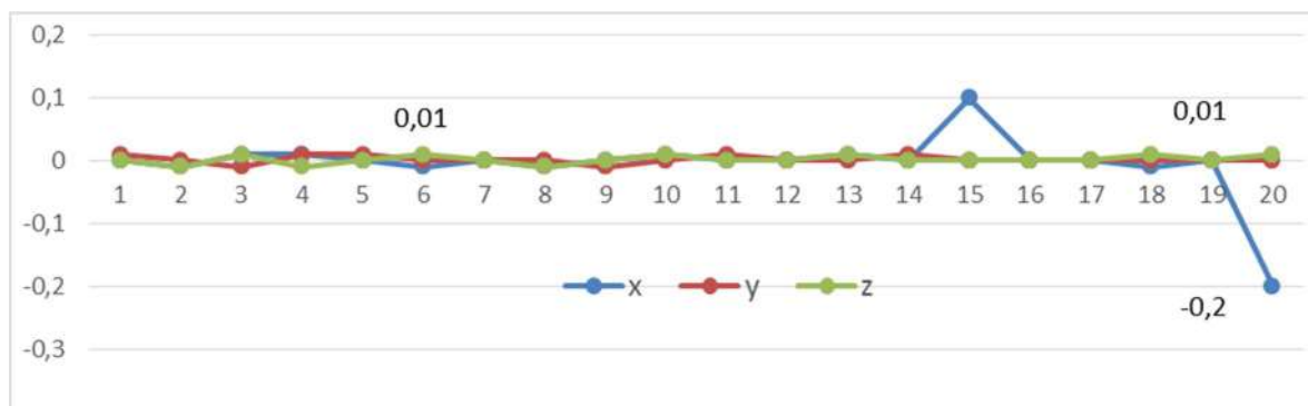
Рисунок 8 – Величина ускорения по трем осям при передвижении транспортного средства по асфальтобетонной дороге
