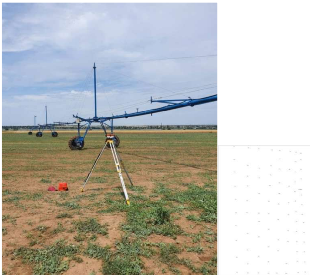
Рисунок 1 – Проведение тахеометрической съемки с целью получения геодезических данных орошаемого участка
