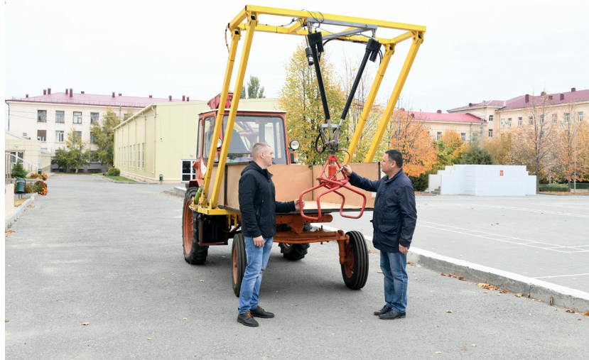
Декан ИТФ Иван Несмиянов и аспирант Максим Николаев на фоне своей разработки – робота-манипулятора для сбора сеток с овощами
