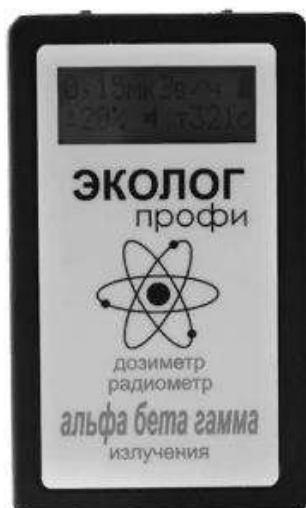
Рисунок 17 - Профессиональный дозиметр-радиометр "ЭКОЛОГ профи"
