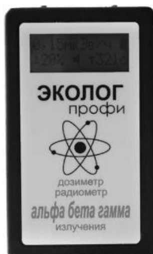
Рисунок 17 - Профессиональный дозиметр-радиометр "ЭКОЛОГ профи"
