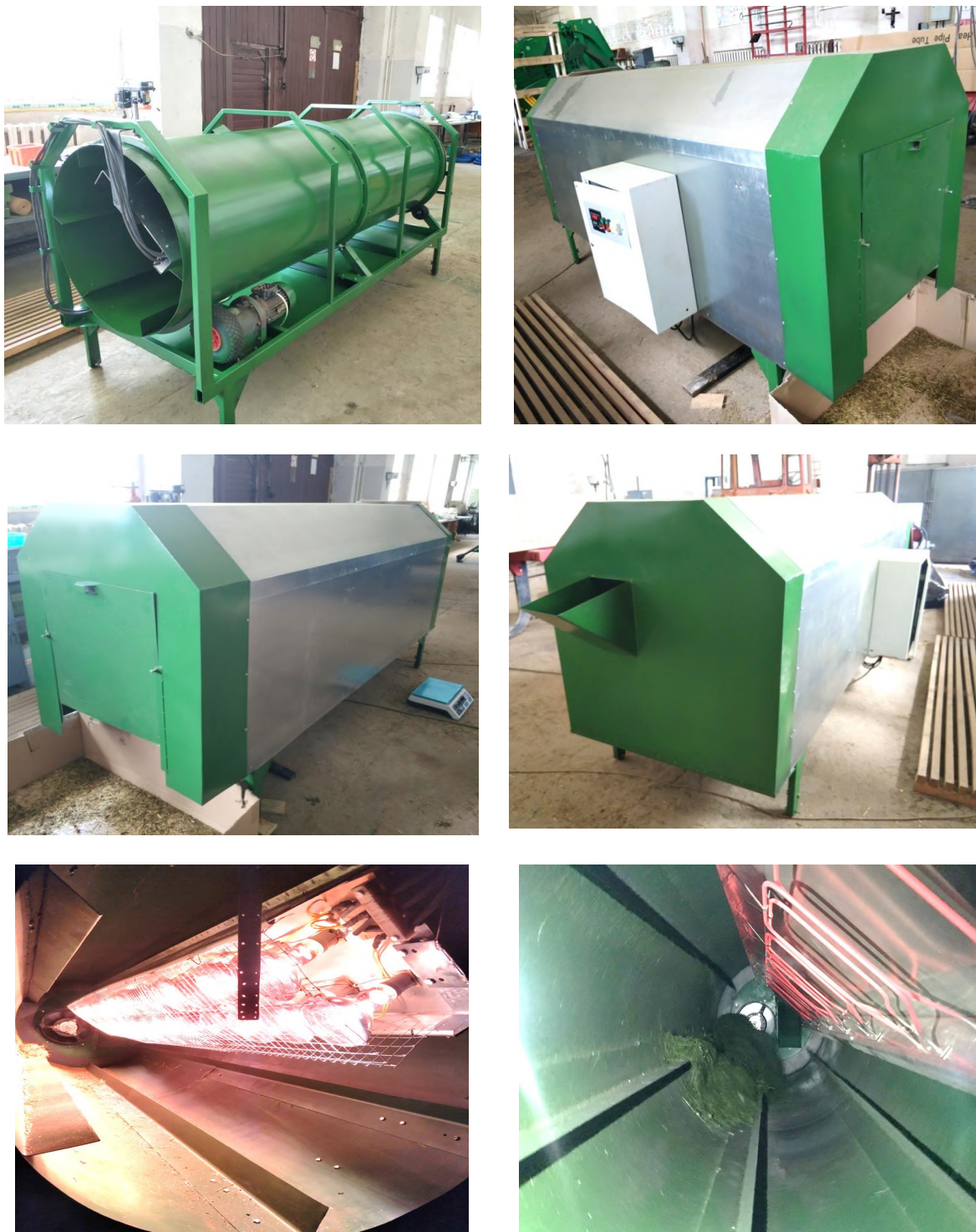
Рисунок 3 – Экспериментальный образец барабанной сушиллки с инфракрасным источником тепла
