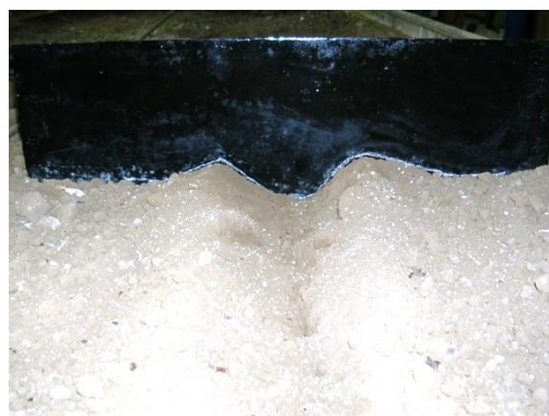
Рисунок 4 – Определения профиля борозды / Figure 4 – Definitions of the furrow profile
