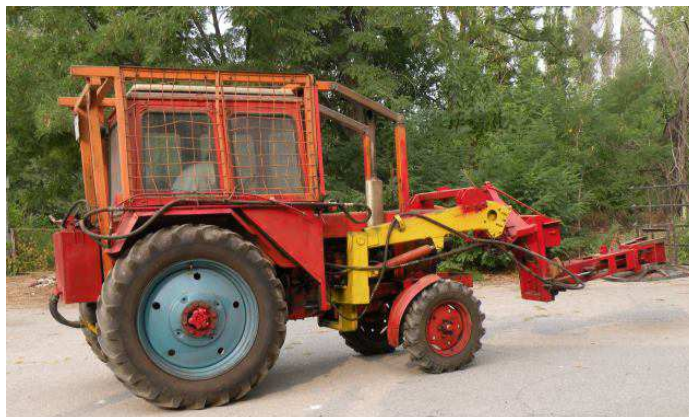
Рисунок 3 – Машина лесохозяйственная блочно-модульная МЛМ-3: модуль для срезания кустарников
