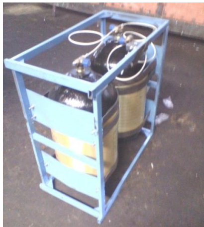
Рисунок 2 – Кассетный модуль емкостью 134 л
