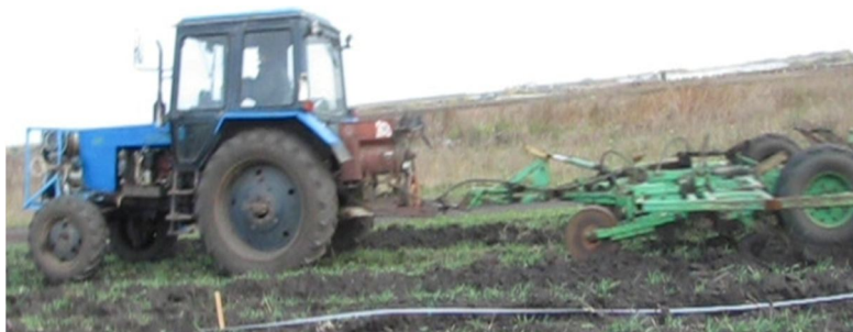
Рисунок 3 – Обработка почвы машинно-тракторным агрегатом МТЗ-82.1+ОПО-4,25
