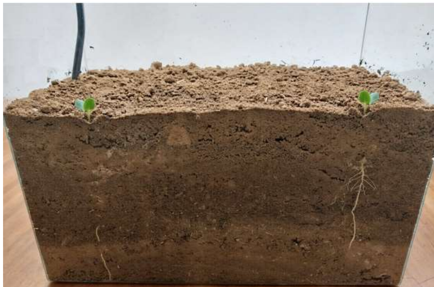
Рисунок 11 - Установка для исследования развития корневой системы
