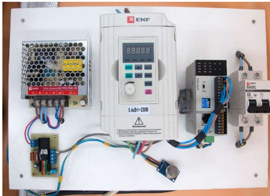
Рисунок 11 – Блок управления системы контроля состава воздушной среды Figure 11 – Control unit of the air composition control system
