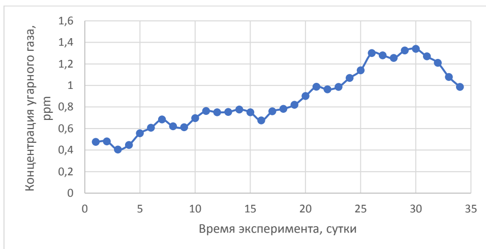
Рисунок 9 – Изменение концентрации угарного газа ( CO ) в течение эксперимента Figure 9 – Change in carbon monoxide ( CO ) concentration over the course of the experiment
