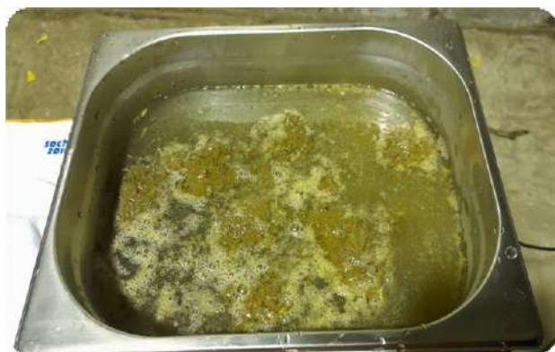
Рисунок 1 – Процесс обработки свиного бесподстилочного навоза в ультразвуковой ванне Figure 1 – Process of treating pig litterless manure in an ultrasonic bath
