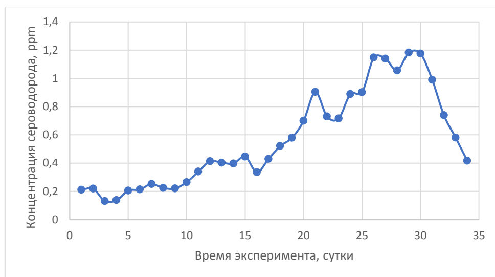
Рисунок 7 – Изменение концентрации сероводорода ( H_2S ) в течение эксперимента Figure 7 – Change in hydrogen sulfide concentration ( H_2S ) during the experiment
