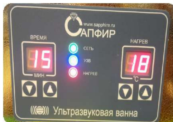
Рисунок 2 – Консоль управления параметрами ультразвуковой ванны при обеззараживании Figure 2 – Console for controlling ultrasonic bath parameters during disinfection
