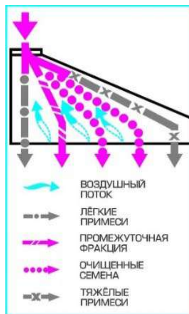
Рисунок 3 – Общий вид и технологическая схема пневматического сортировального стола МОС-9Н Figure 3 – General view and flow diagram of the MOS-9N pneumatic sorting table
