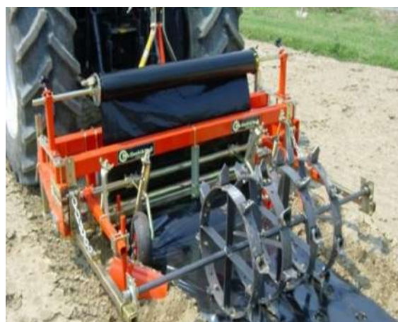
Рисунок 2 – Пленкоукладчик с устройством для проделывания отверстий Figure 2 – A film-laying machine with a device for making holes
