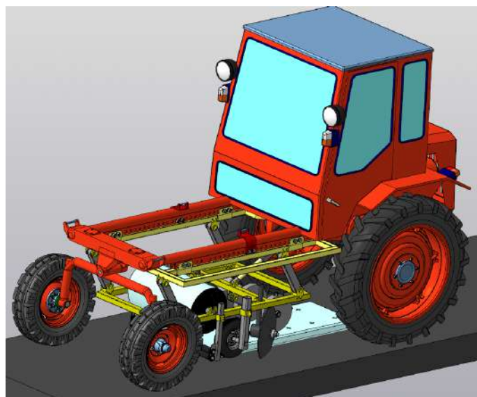
Рисунок 6 – 3Д модель модуля для укладки мульчирующей пленки на базе тракторного самоходного шасси ВТЗ-30СШ
