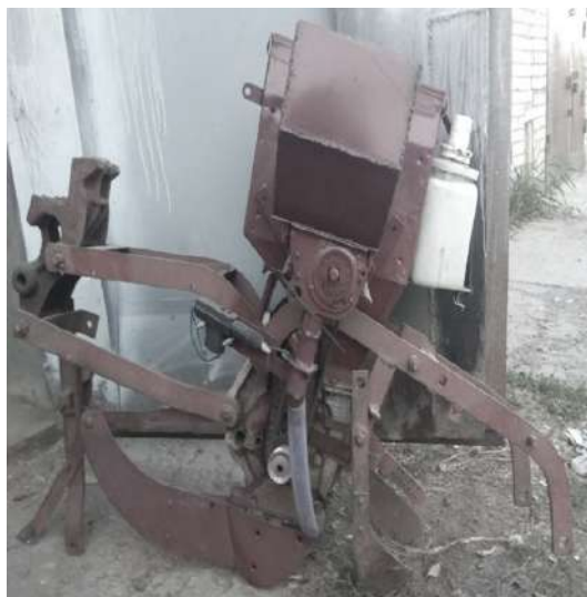
Рисунок 3 – Общий вид секции сеялки для посева семян сои с подачей насыщенного гидрогеля (патент № RU 2748807 C1)
