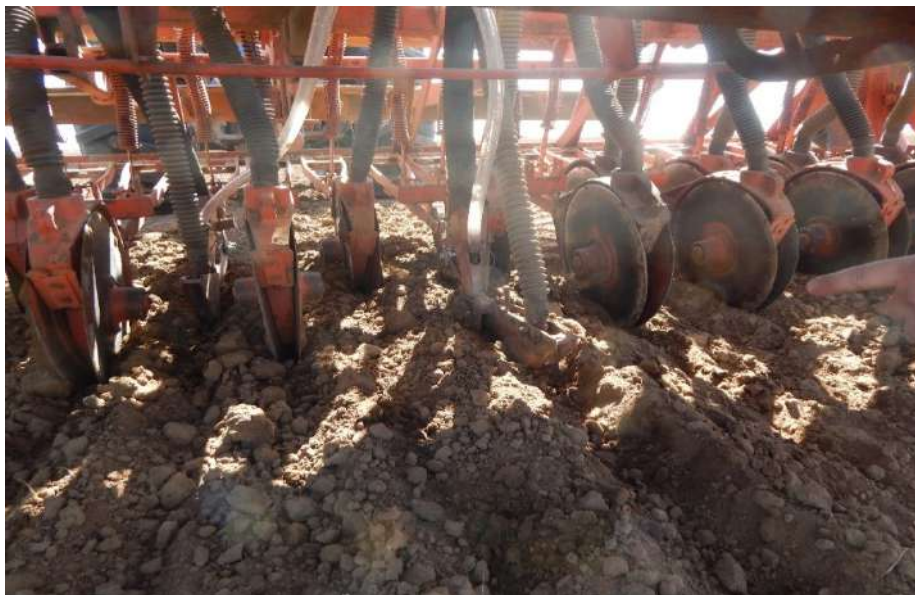
Рисунок 1 – Общий вид зерновой сеялки, переоборудованной сошниками для посева семян ячменя с обогащенным гидрогелем (патент RU 2577370 C1)
