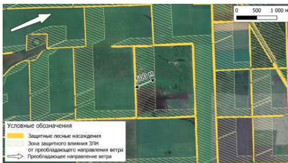
Рисунок 3 – Схема зоны защитного влияния лесополос от преобладающих ветров на полях на чернозёмах обыкновенных
