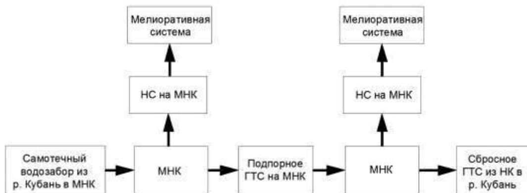
Рисунок 5 – Линейная схема подачи воды из магистрального Новокубанского канала на орошение земель Новокубанского и Гулькевичского районов
