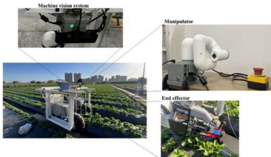
Рисунок 1 – Роботизированный комбайн для сбора клубники, включающий систему машинного зрения, манипулятор, рабочий орган и наземную платформу [12]
