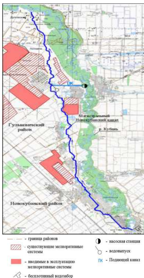
Рисунок 2 – Линейная схема магистрального Новокубанского канала с мелиоративными системами Figure 2 – Linear diagram of the main Novokubansky Canal with drainage systems
