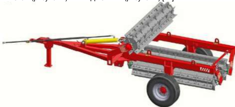
Рисунок 1 – Каток-измельчитель пожнивных остатков КИПО-6Н Figure 1 – KIPO-6N stubble shredder roller
