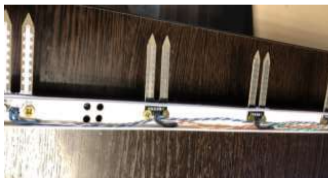
Рисунок 2 – Расположение сенсоров на одном датчике влажности Figure 2 – Location of sensors on a single humidity sensor
