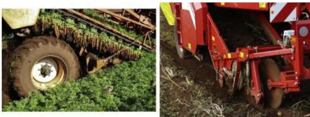
Рисунок 3 – Современные буксируемые однорядные морковуборочные (слева) и картофелеуборочные (справа) комбайны бункерного типа [27]
