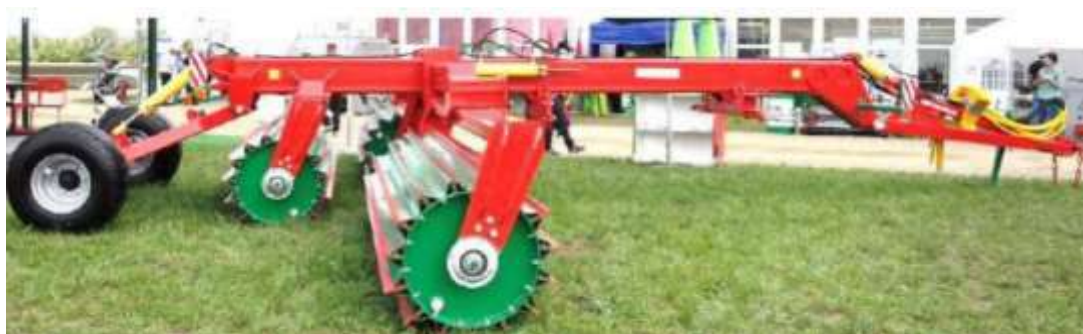
Рисунок 2 – Каток-измельчитель пожнивных остатков ИР «ДАСТЕР» Figure 2 – IR "Duster" stubble shredder roller
