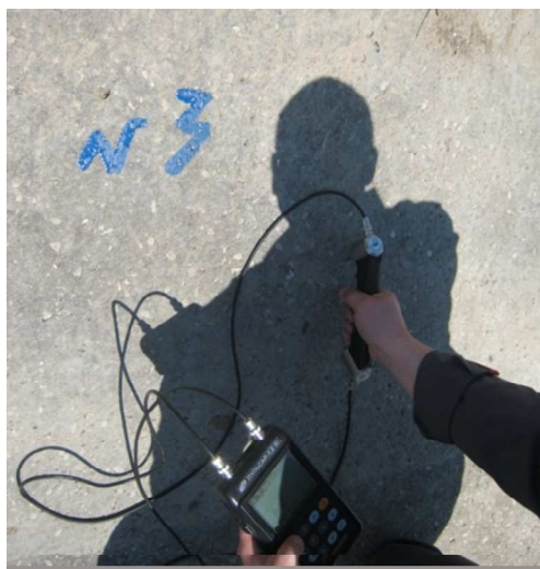
Рисунок 5 – Определение скорости ультразвуковой волны противофильтрационной облицовки на Большой Волгоградской оросительной системе
