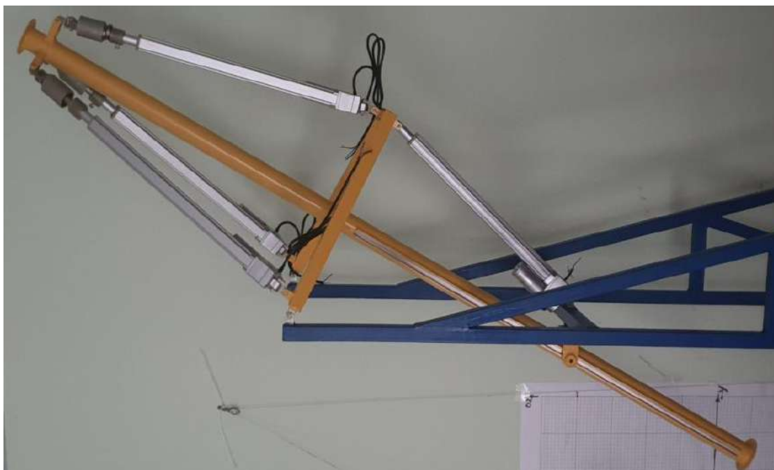
Рисунок 2 – Фотография манипулятора гибридной структуры с дополнительным звеном Figure 2 – Photo a hybrid structure manipulator with an additional link
