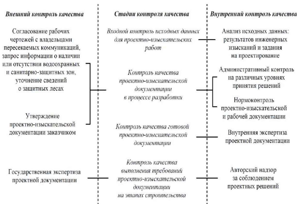
Рисунок 1 – Структура системы контроля качества проектно-изыскательской документации Figure 1 – Quality System Structure design and survey documentation
