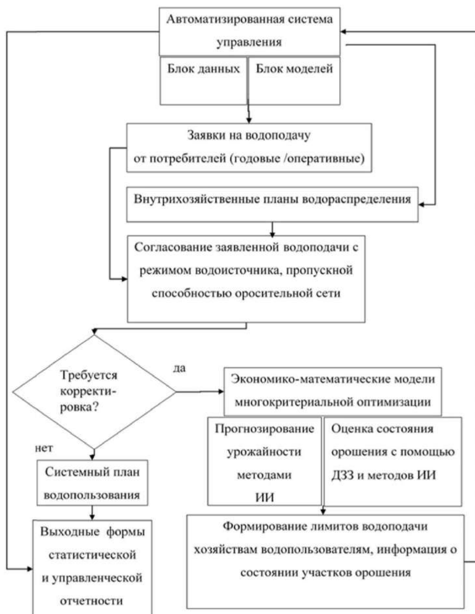
Рисунок 1 – Алгоритм автоматизированного планирования системного водораспределения Figure 1 – Algorithm of automated planning of system water distribution
