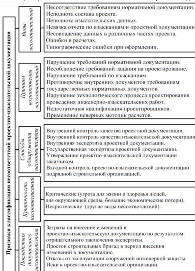
Рисунок 4 – Классификация несоответствий проектно-изыскательской документации требованиям неотрывных актов
