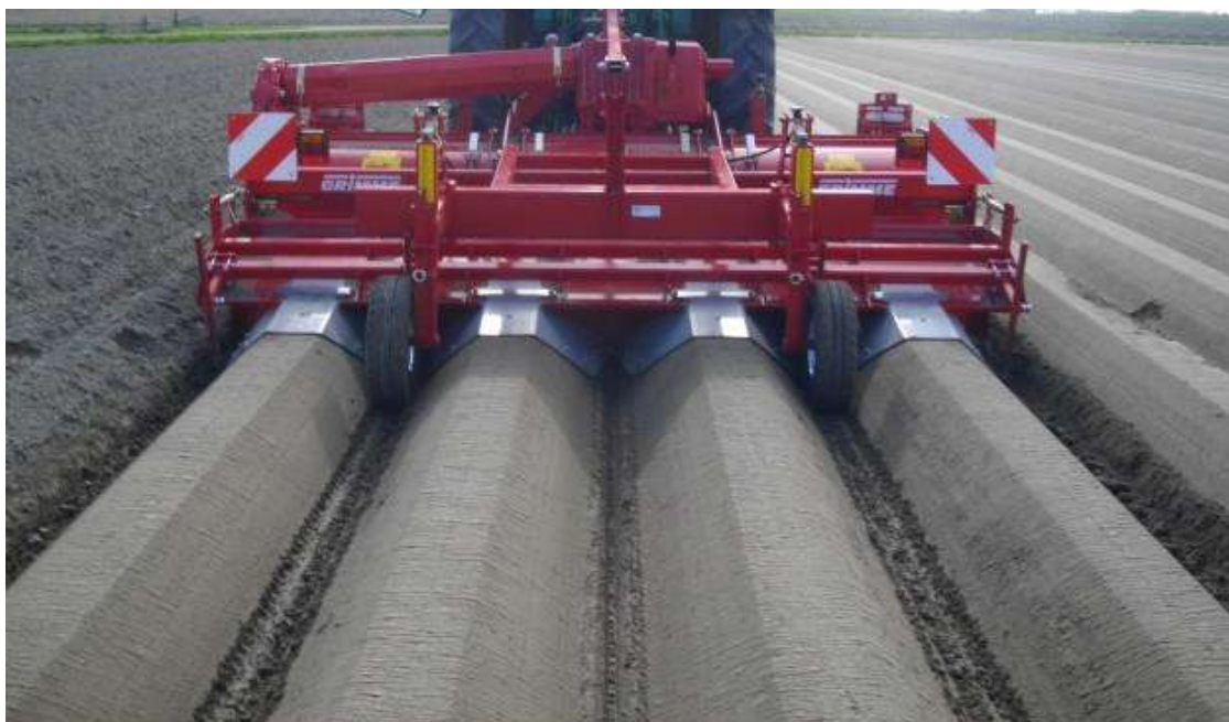
Рисунок 7 – Пропашной фрезерный культиватор-гребнеобразователь с активными рабочими органами Figure 7 – Inter-row rotary cultivator-ridge former with active knives
