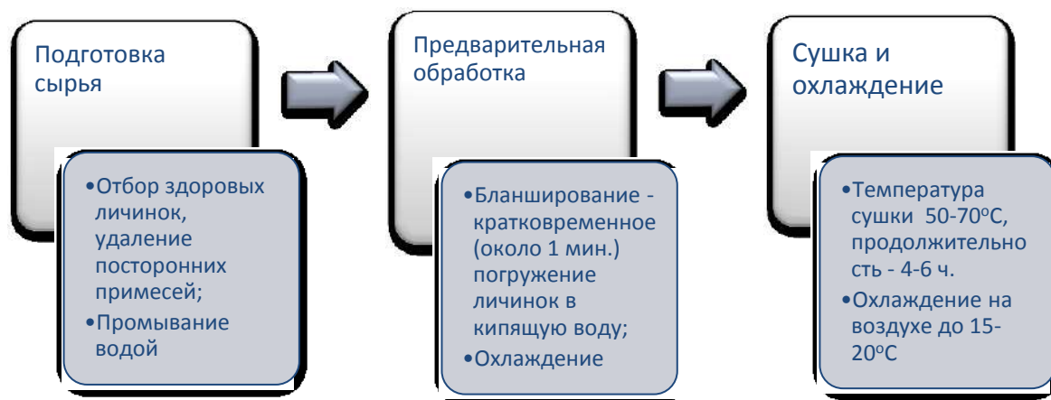
Рисунок – Блок-схема технологического процесса сушки личинок Figure – Block diagram of the technological process of drying larvae
