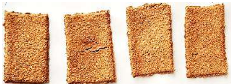
Рисунок 3 – Образцы с содержанием наполнителя в количестве 31,92 % Figure 3 – Samples with 31.92% filler content
