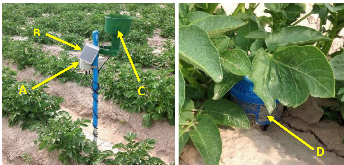
Рисунок 8 – Измерительный комплекс для регистрации температуры наружного воздуха, уровня осадков, температуры и влажности почвы с шагом 10 см на глубину 90 см: A – модем; B – солнечная батарея; C – осадкомер; D – почвенный зонд для послойного измерения температуры и влажности почвы
