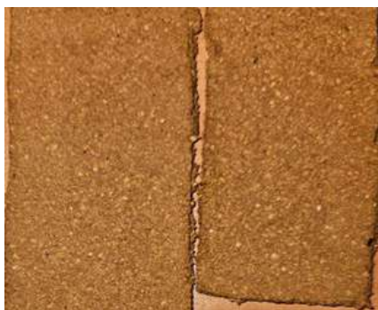
Рисунок 9 – Образцы, полученные методом раскатки прижимным валом Figure 9 – Samples obtained by roller pressing
