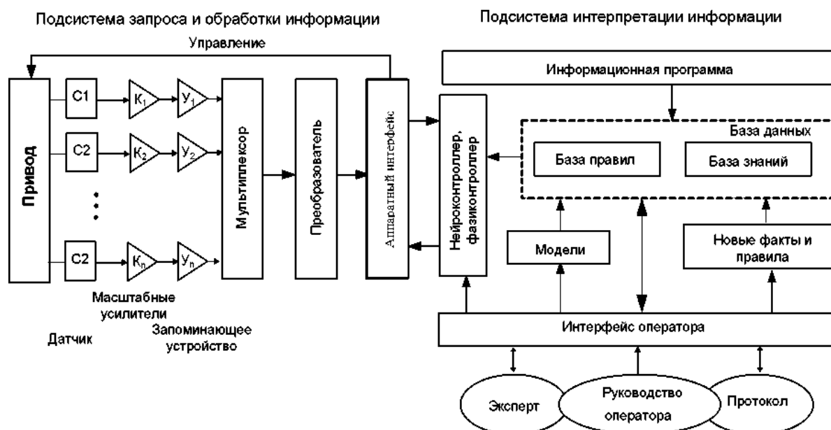
Рисунок 2 – Система диагностики неисправностей Figure 2 – Fault diagnostic system
