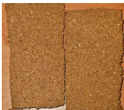
Рисунок 10 – Образцы, полученные методом раскатки прижимным валом с добавлением желатина Figure 10 – Samples obtained by roller pressing with gelatin addition
