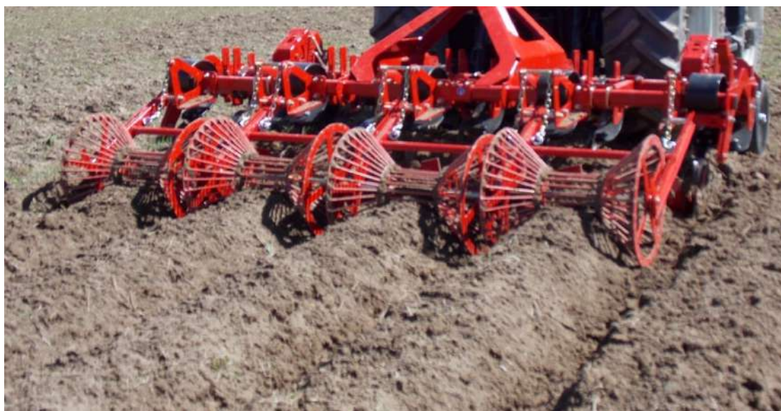
Рисунок 6 – Пропашной культиватор-глубокорыхлитель с пассивными рабочими органами Figure 6 – Inter-row cultivator-subsoiler with passive working tines
