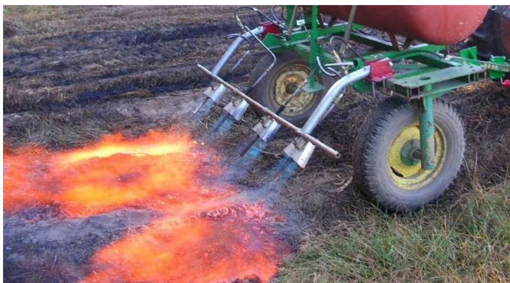
Рисунок 2 – Термическая обработка почвы Figure 2 – Thermal tillage
