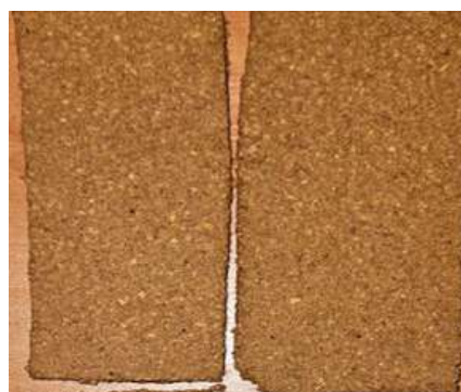
Рисунок 12 – Образцы, полученные методом прессования с добавлением желатина Figure 12 – Samples obtained by pressing with gelatin addition
