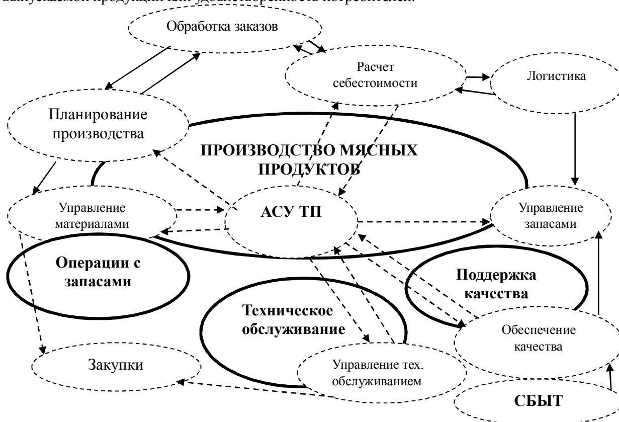
Рисунок 4 – Взаимосвязь компонентов MES-системы и автоматизированные системы управления технологическими процессами
