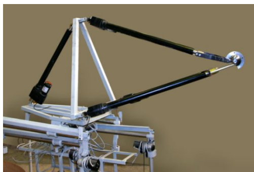
Рисунок 3 – Манипулятор-трипод в составе мобильного робота на шагающем шасси
