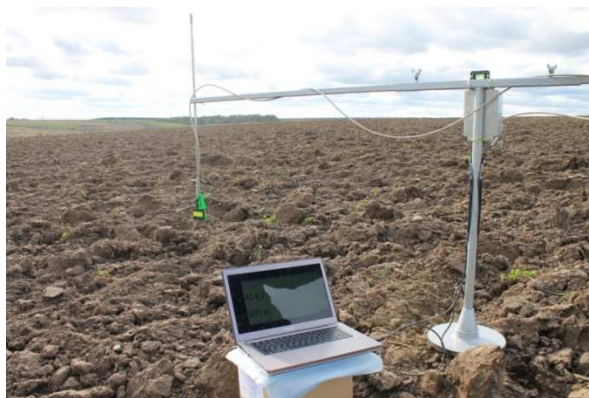
Рисунок 2 – Общий вид изготовленного профилографа, расположенного на пашне
