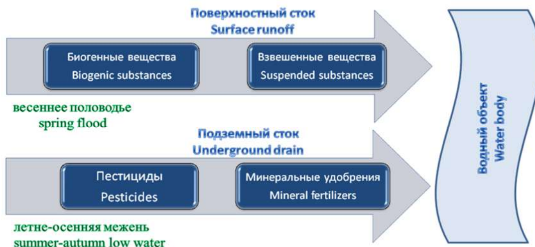
Рисунок 2 – Схема поступления загрязняющего вещества в водный объект
