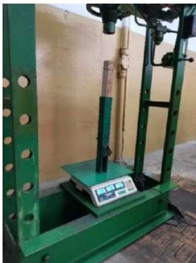
Рисунок 3 – Стенд для оценки усилия резания корнеклубнеплодов
