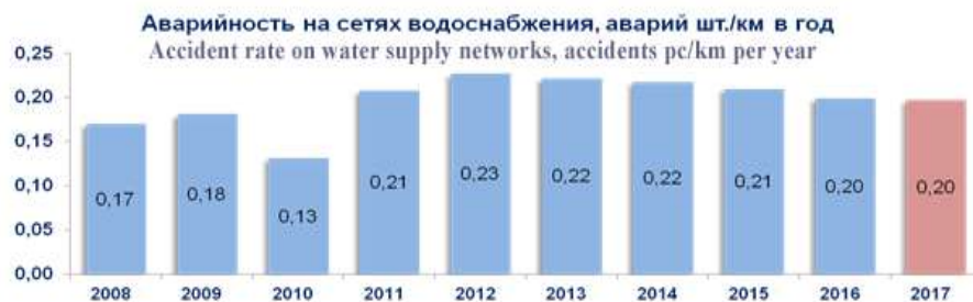
Рисунок 3 – Аварийность на сетях водоснабжения, аварий шт./км в год
