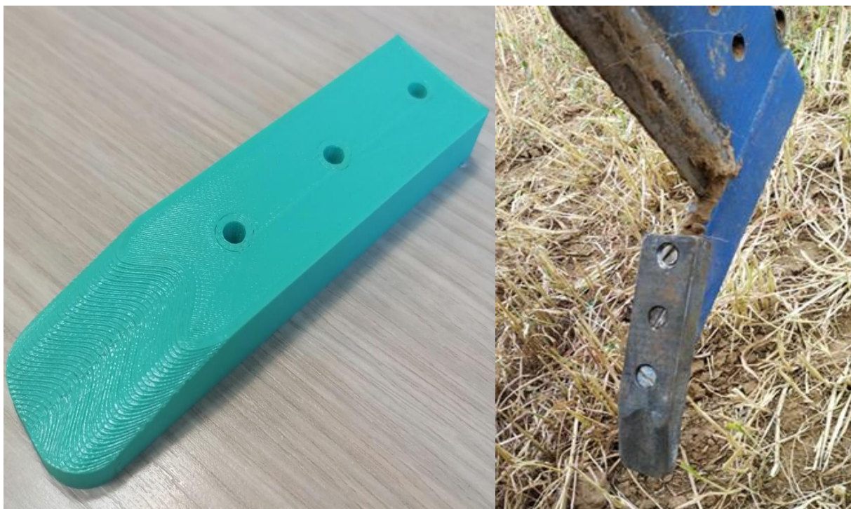
Рисунок 3 – Модель экспериментального рабочего органа, полученная посредством 3D-печати и общий вид экспериментального рабочего органа чизельного плуга
