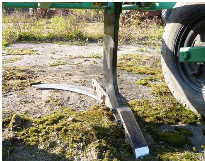
Рисунок 1 – Общий вид динамичного рабочего органа с серпообразной односторонней лапой
