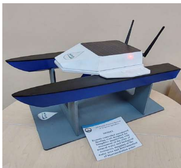
Рисунок 6 – Модель дистанционно управляемого, автоматизированного плавсредства, предназначенного для проведения биосферного мониторинга на водоемах
