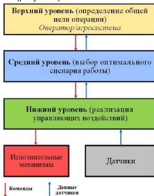
Рисунок 1 – Архитектура ЭСУ последовательного гибридного трактора с мотор-колесами Figure 1 – Architecture of the ECS of a serial hybrid tractor with hub motors
