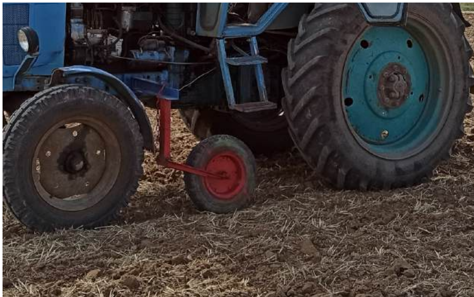
Рисунок 9 – Измерение фактической скорости МТА по полю при помощи «пятого колеса» Figure 9 – Measuring the actual speed of the MTA in the field using the "fifth wheel"
