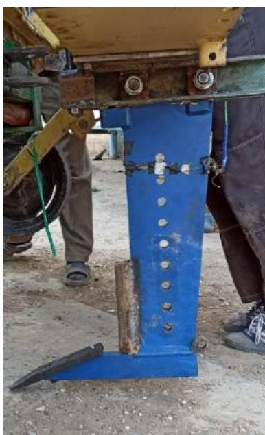
Рисунок 6 – Стойка «РАНЧО» со стандартным чизельным долотом и тензодатчиками Figure 6 – The "Rancho" rack with a standard chisel bit and load cells
