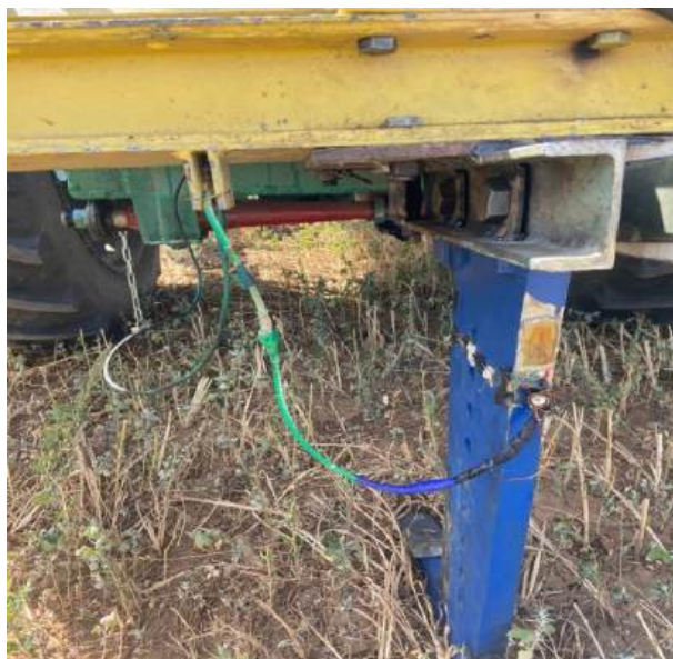
Рисунок 5 – Измерение горизонтальной составляющей тягового сопротивления чизельной стойки
