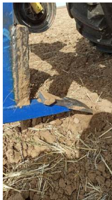
Рисунок 7 – Стойка «РАНЧО» с экспериментальным чизельным долотом с боковым сегментированием Figure 7 – The "Rancho" stand with an experimental chisel bit with lateral segmentation
