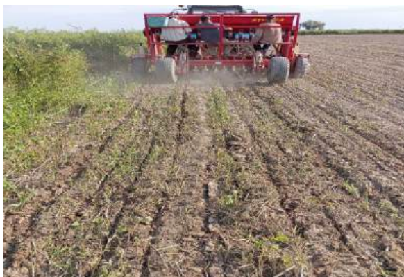
Рисунок 1 – Посев кунжута на сеялке «АТМАСА-17» без обработки почвы Figure 1 – Sowing sesame on the ATMASA-17 seeder without soil cultivation
