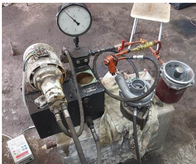
Рисунок 1 – Комбинация элементов, входящих в состав автономной смазочной станции Figure 1 – Combination of elements included in the autonomous lubrication station
