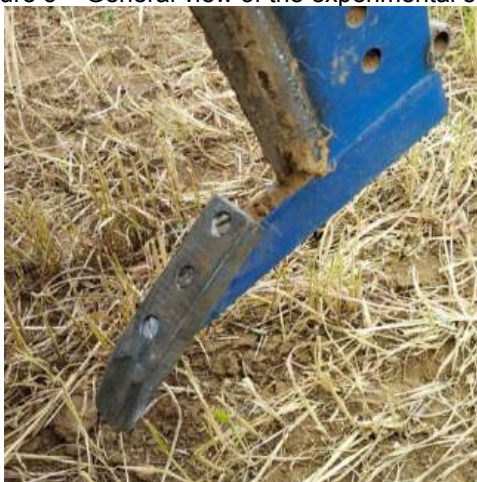
Рисунок 4 – Общий вид экспериментальных рабочих органов чизельного плуга Figure 4 – General view of the experimental working bodies of the chisel plow
