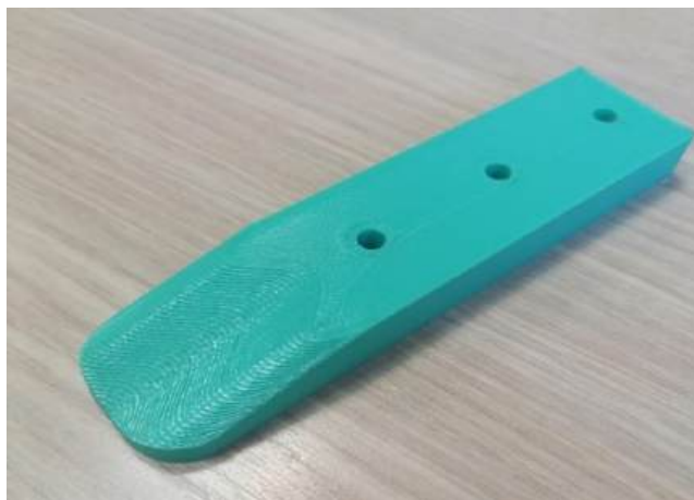
Рисунок 2 – Модель экспериментального рабочего органа, полученная посредством 3D-печати
