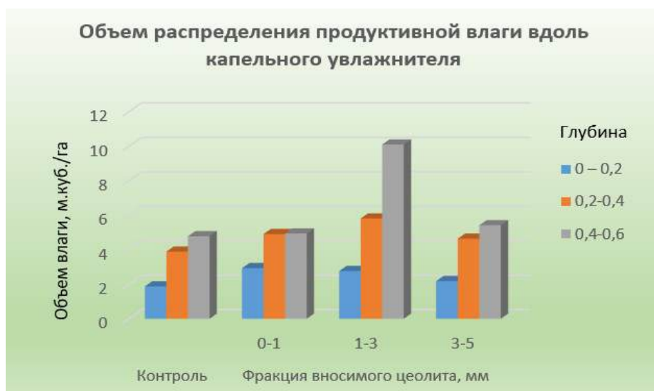
Рисунок 5 – Суммарный объем распределения влаги в почве вдоль линии вокруг капельного увлажнителя в радиусе 40 см на различной глубине через 5 дней после увлажнения нормой 200 м 3 /га, в зависимости от фракции вносимого цеолита
