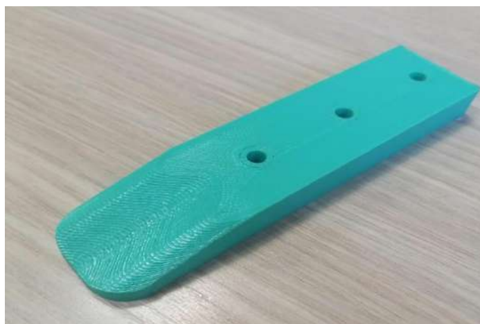
Рисунок 2 – Модель экспериментального рабочего органа, полученная по средствам 3D – печати
