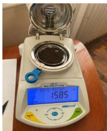
Рисунок 3 – Оборудование для определения влажности почвы в лабораторных условиях (анализатор влажности Adam PMB 202) Figure 3 – Equipment for determining soil moisture in laboratory conditions (Adam PMB 202 moisture analyzer)
