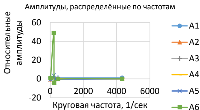
Рисунок 6 – Распределение относительных амплитуд по частотам собственных колебаний для 6-и массовой схемы с ДВС Figure 6 – Distribution of relative amplitudes by natural oscillation frequencies for a 6-mass circuit with an internal combustion engine
