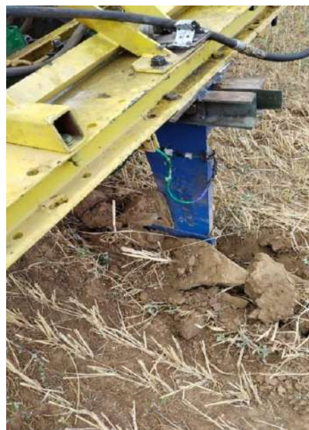
Рисунок 3 – Общий вид экспериментальной установки по определению тягового сопротивления рабочей секции чизельного орудия
