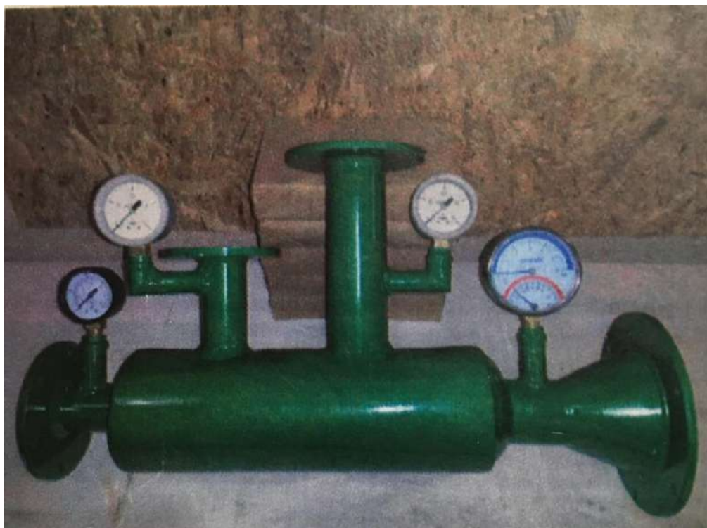
Рисунок 4 – Кольцевой двухповерхностный струйный аппарат. Общий вид Figure 4 – An annular two-surface inkjet device. The general view
