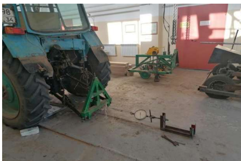
Рисунок 5 – Тарирование устройства для измерения горизонтального усилия от сельскохозяйственной машины, навешиваемой на трактор Figure 5 – Tare of a device for measuring the horizontal force from an agricultural machine hung on a tractor
