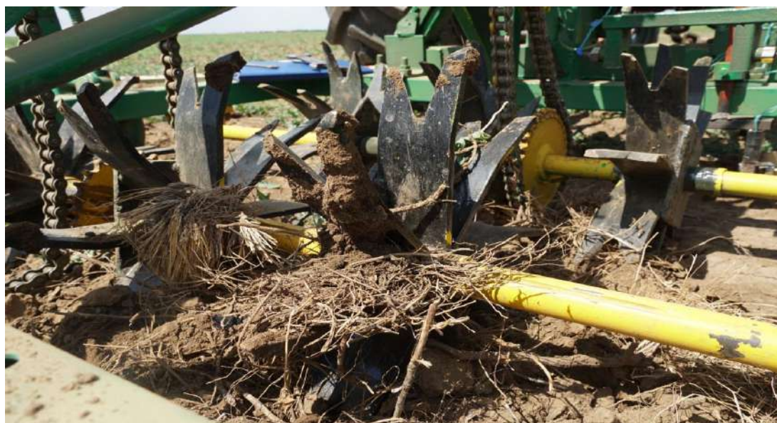
Рисунок 4 – Общий вид машины для вычесывания сорняков с рабочими органами в виде скоб с внутренними вырезами ножей Figure 4 – General view of a weed combing machine with shackles with internal knife cutouts
