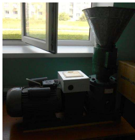
Рисунок 2 – Малый пресс-гранулятор модель ZLSP D-Type 120
