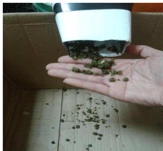
Рисунок 3 – Гранулы из тростника южного из растений: а – без метелки; б – с наличием метелок
