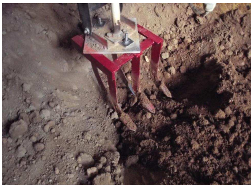
Рисунок 4 – Испытание модели в грунтовом лотке
