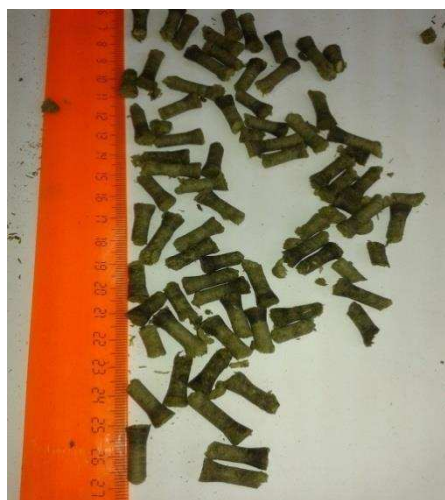
Рисунок 3 – Гранулы из тростника южного из растений: а – без метелки; б – с наличием метелок
