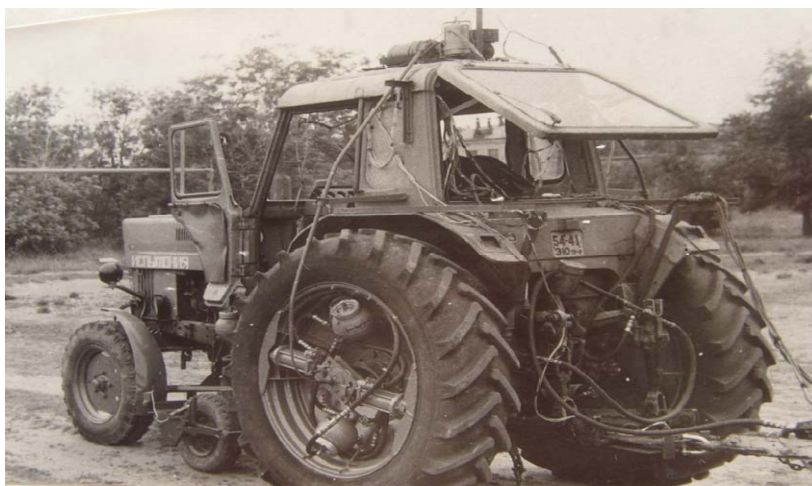
Рисунок 1 – Размещение giroагрегатов и преобразователя на крыше кабины трактора
