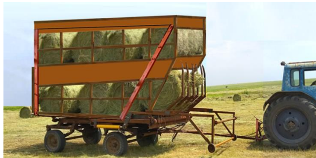
Рисунок 2 – Погрузчик-транспортировщик рулонов сена ПТРС-2
