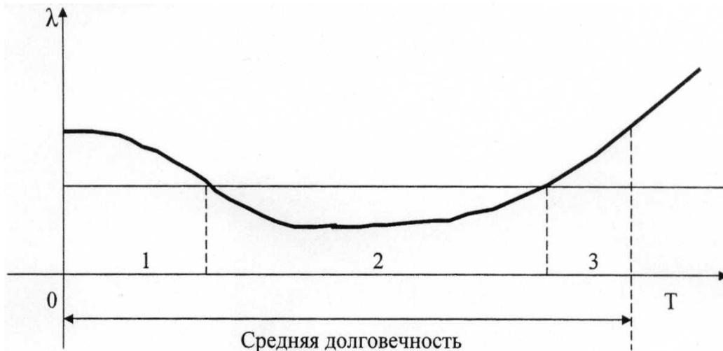
Рисунок 1 – График кривой зависимости интенсивности отказов элементов оросительной системы от времени
