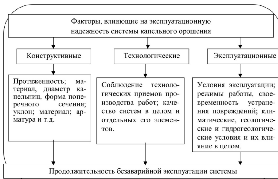
Рисунок 2 – Структурная схема основных факторов, влияющих на эксплуатационную надежность системы капельного орошения
