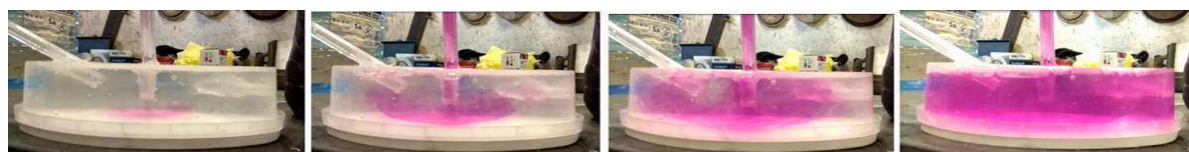
Рисунок 3 – Первый вариант подачи топлива в камеру ультразвуковой обработки топлива
