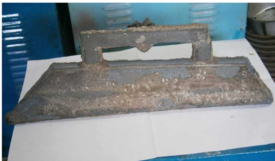
Рисунок 3 – Лемех, изготовленный методом литья
