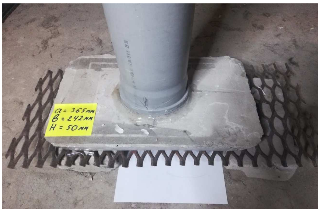
Рисунок 6 – Установка с бетонной плитой
