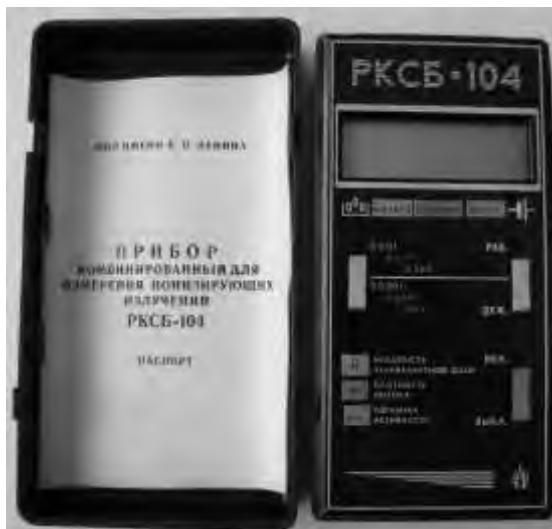
Рисунок 15 - Бытовой дозиметр РКСБ-104
