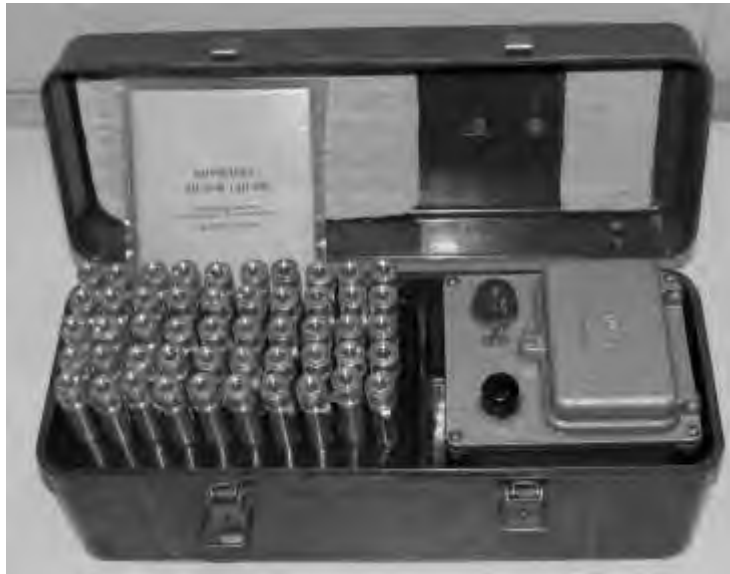
Рисунок 10 - Комплект дозиметров ДП-22В
