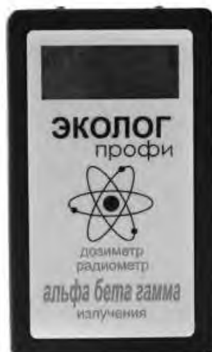
Рисунок 17 - Профессиональный дозиметр-радиометр "ЭКОЛОГ профи"
