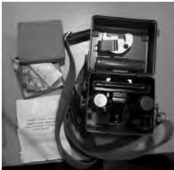
Рисунок 13 - Химический дозиметр ДП-70МП
