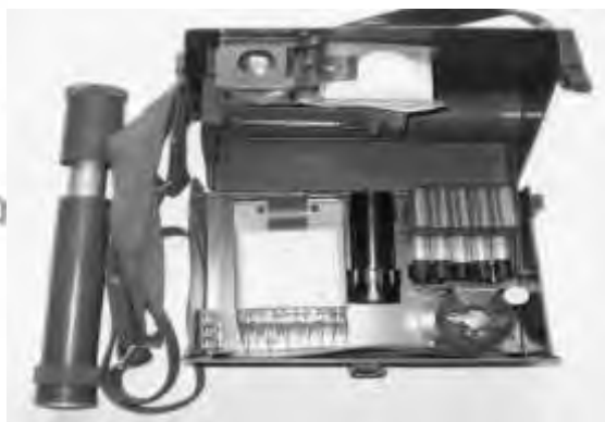
Рисунок 6 - Прибор химической разведки ВПХР
