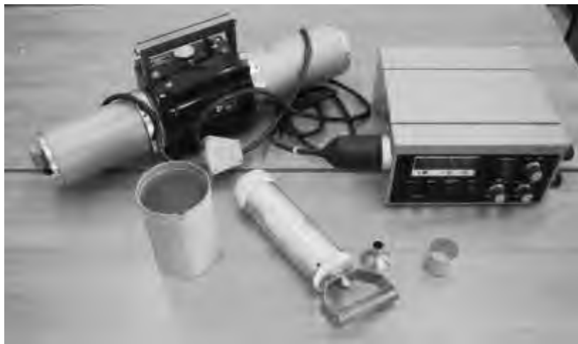
Рисунок 4 – Радиометр контроля бета – излучения РКБ4-М
