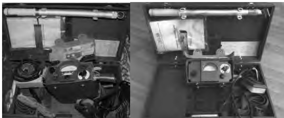
Рисунок 9 - Прибор ДП-5Б, 5В.
