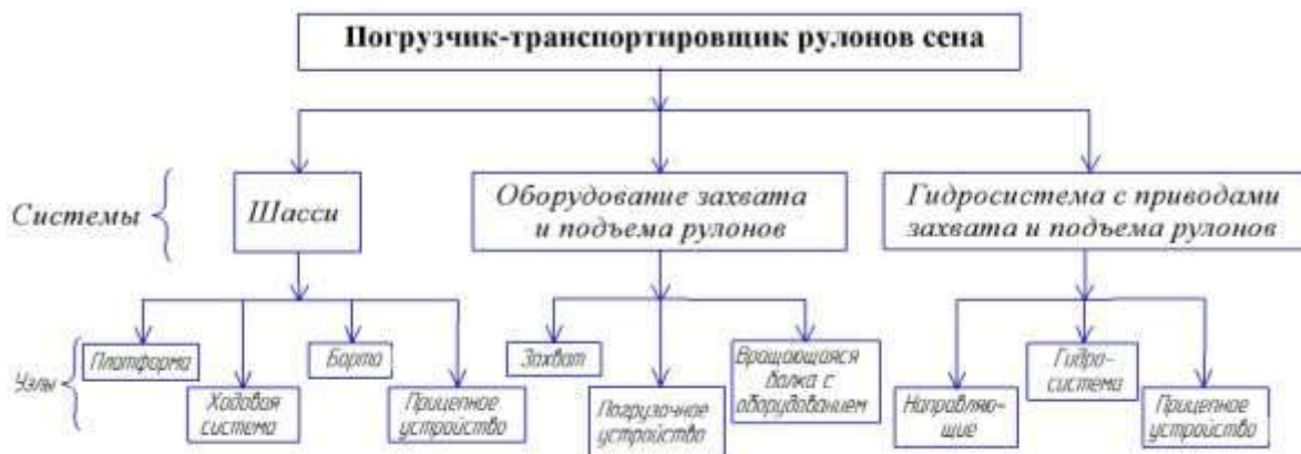
Рисунок 4 – Структурная схема погрузчика-транспортровщика рулонов сена
