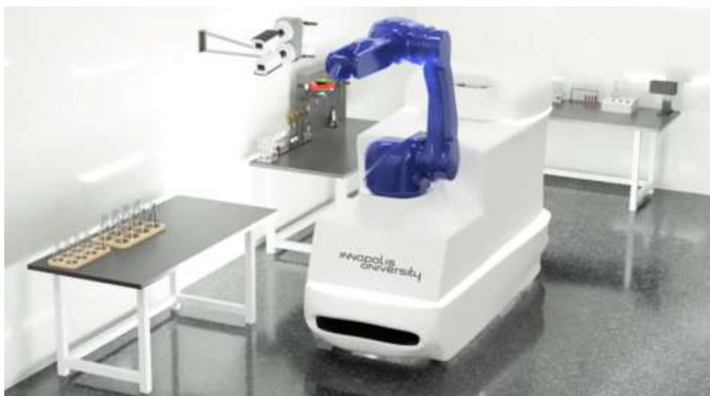
Рисунок 1 – Гибридный робот, разработанный для обслуживания нескольких рабочих мест в лаборатории
