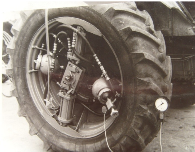
Рисунок 1 – Контроль начального давления газа в пневмогидроаккумуляторе перед экспериментом
