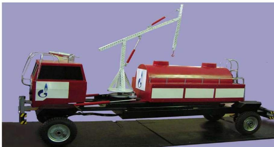
Рисунок 3 – Действующая модель транспортного средства повышенной проходимости (с грузоподъемным механизмом) с максимальным расстоянием между осями колес
