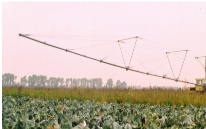
Рисунок 1 – Дождевальная машина ДКДФ-1П
