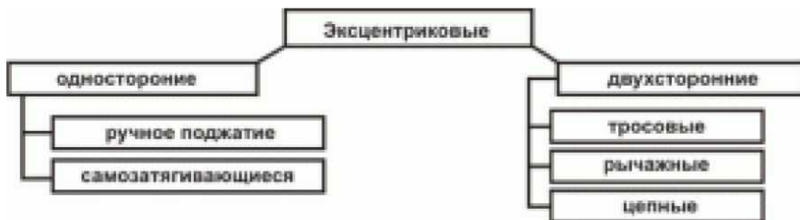
Рисунок 3 - Классификация эксцентриковых грузозахватных устройств
