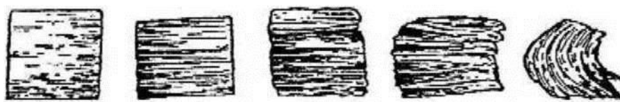
12 Рисунок 2 - Оценка консистенции масла пробой на срез
