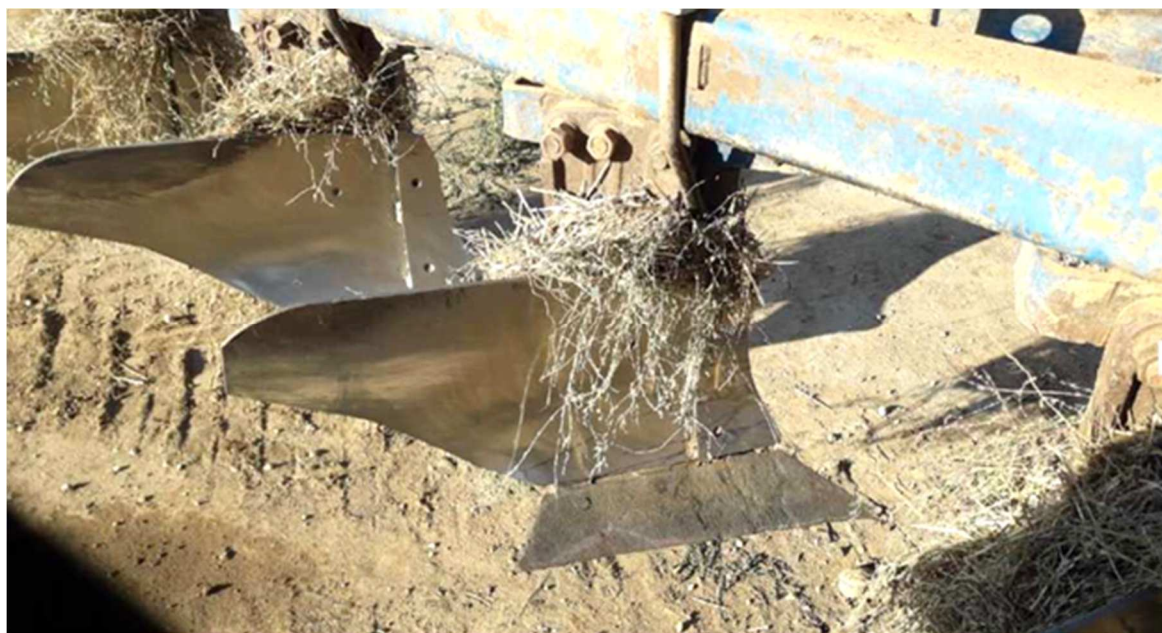
Рисунок 5 – Корпус плуга с установленным экспериментальным лемехом после сменной наработки
