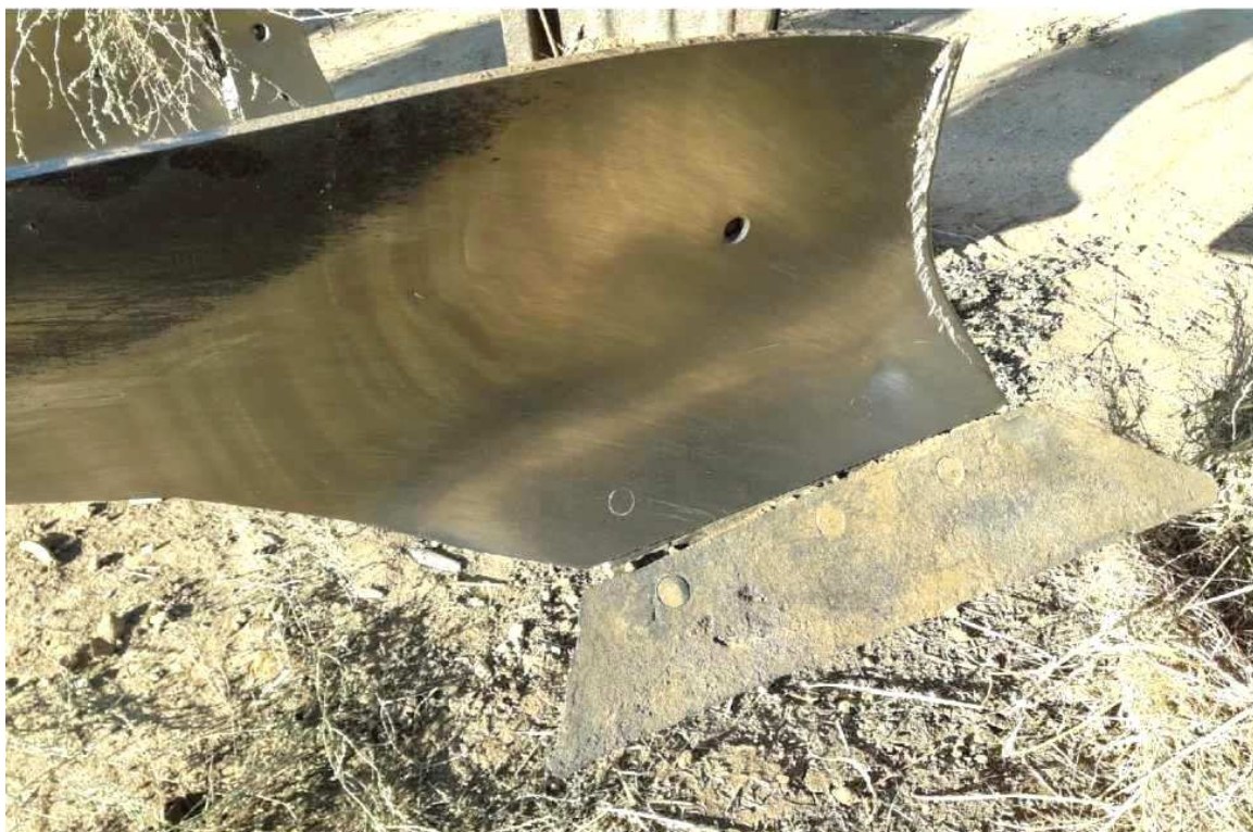
Рисунок 4 – Корпус плуга с установленным лемехом, изготовленным методом литья с поверхностным легированием
