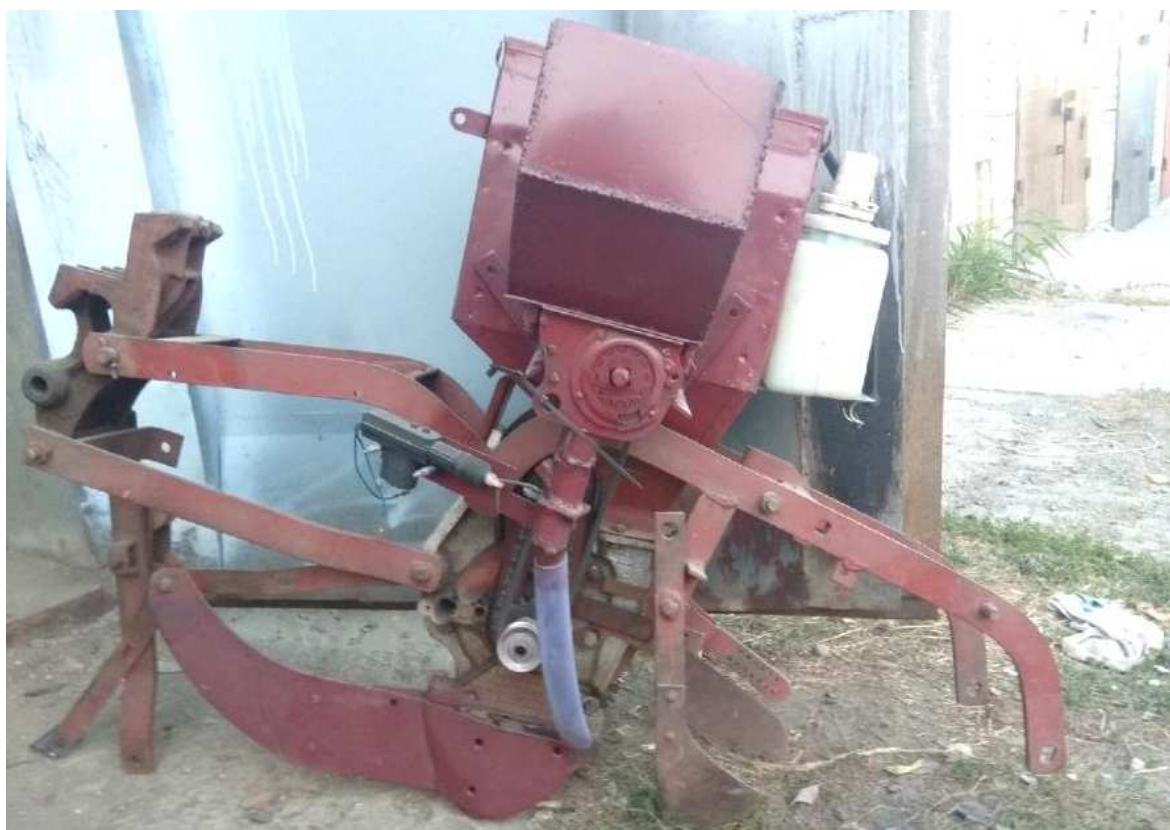
Рисунок 2 – Секция сеялки точного высева для посева овощных и бахчевых культур с одновременным внесением обогащенных гранул гидрогеля
