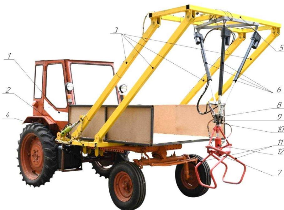
Рисунок 6 – Устройство роботизированного погрузчика сеток
