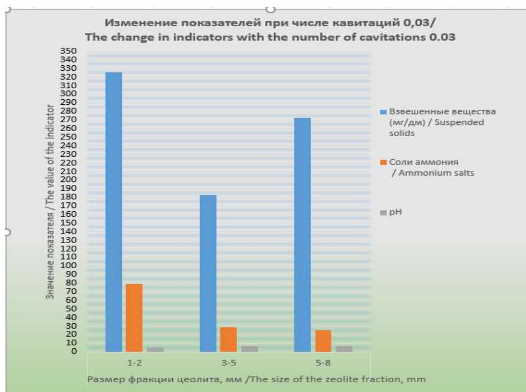
Рисунок 3 – Динамика исследуемых показателей при очистке животноводческих стоков при числе кавитаций 0,03 и различном фракционном составе природного цеолита в сорбционной загрузке Figure 3 – The dynamics of the studied indicators in the treatment of livestock effluents with a number of cavitations of 0.03 and a different fractional composition of natural zeolite in sorption loading
