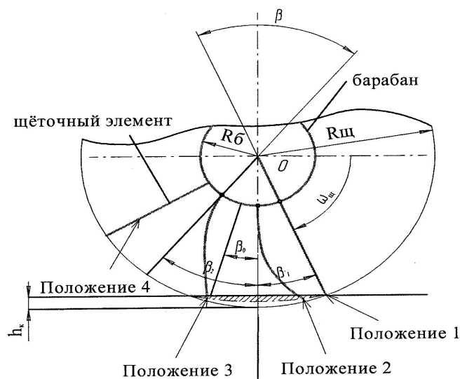
Рис. 1. Взаимодействие щеточного элемента с поверхностью коры плоды тыквы
