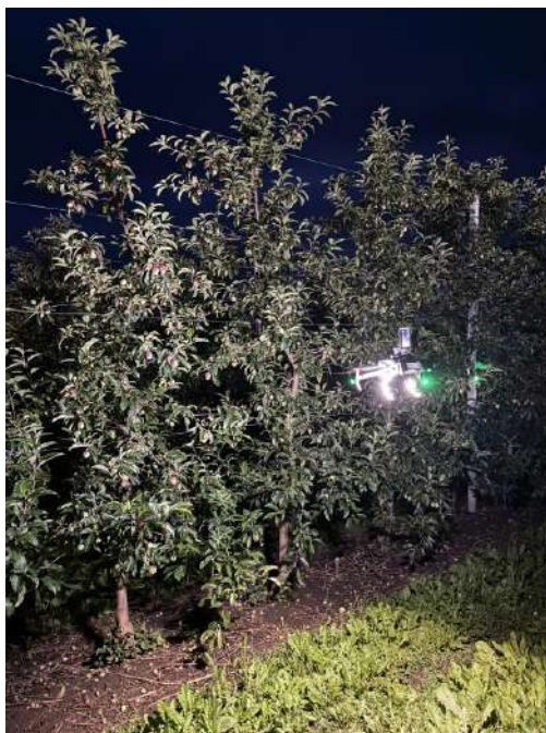
Рисунок 3 – Сбор набора исходных данных (изображений) с помощью квадрокоптера DJI Mavic 3 Multispectral и экшен-камеры DJI Osmo Action 5 Pro
