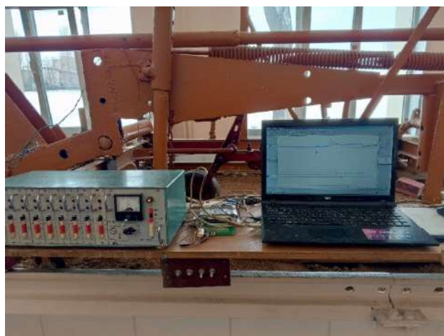
Рисунок 8 – Установка для исследования тягового сопротивления полольных лап Figure 8 – Installation for studying the traction resistance of weeding paws
