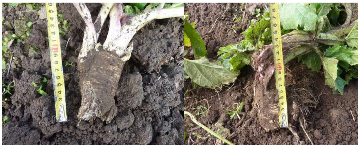
Рисунок 13 – Глубина подрезания корнестебля сорняка рабочим органом с крылом серпообразной формы (с двойным радиусом)
