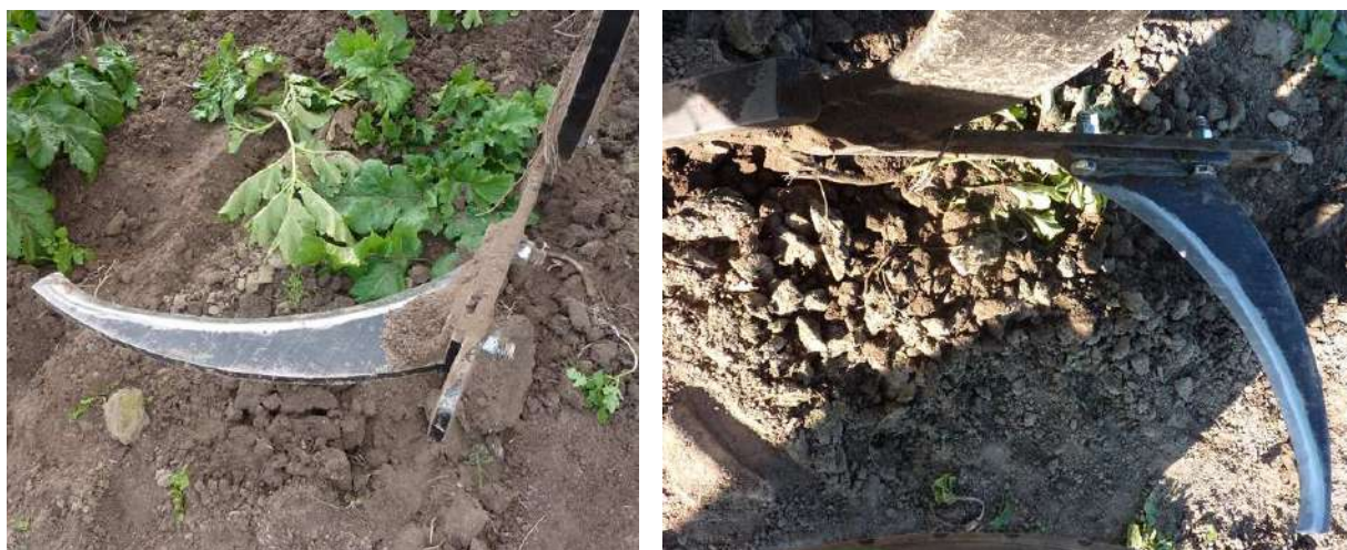
Рисунок 11 – Общий вид рабочего органа крылом серпообразной формы (с двойным радиусом) в процессе проведения исследований
