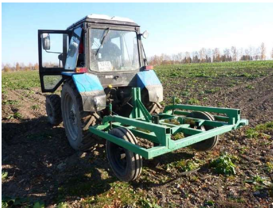
Рисунок 7 – Общий вид измерительно-информационного комплекса ИИК-ИАЭП в агрегате с трактором Беларус-82.1
