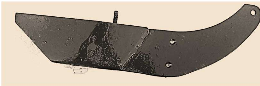
Рисунок 1 – Модернизированный полозовидный сошник для одновременного посева семян сои и бахчевых культур и внесения гранул гидрогеля (вид справа)
