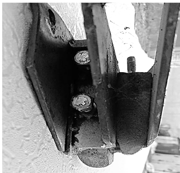
Рисунок 3 – Расположение пят модернизированного сошника (вид сзади)
