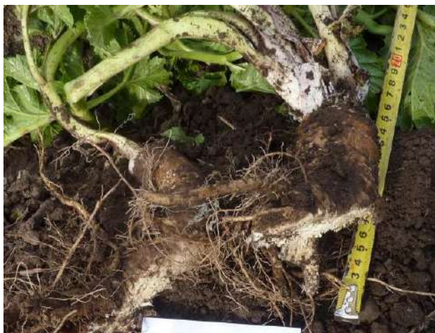
Рисунок 10 – Подрезанная корневая система сорняка рабочим органом с крылом серпообразной формы
