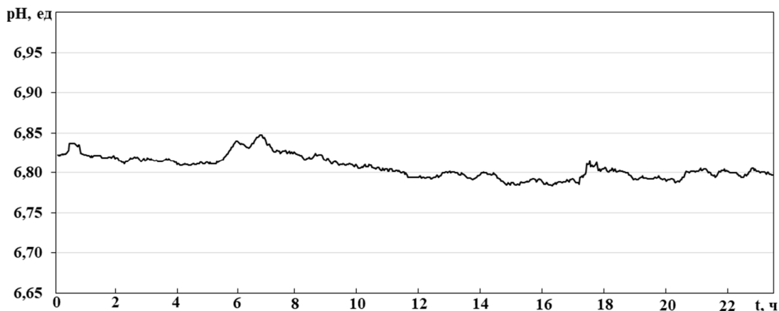
Рисунок 4 – График изменения pH в бассейне при штатном режиме работы
