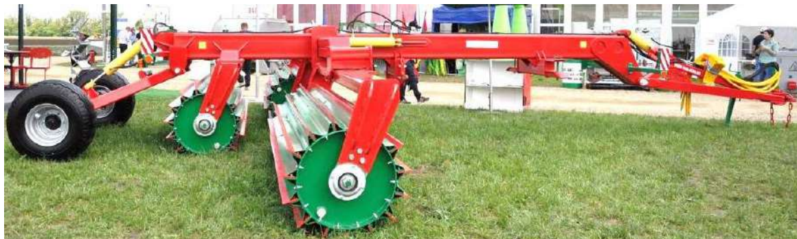
Рисунок 4 – Каток-измельчитель пожнивных остатков ИР «ДАСТЕР»
