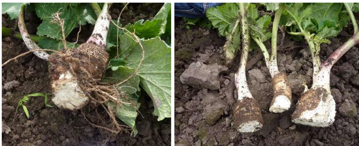
Рисунок 12 – Подрезанная корневая система сорняка рабочим органом с крылом серпообразной формы (с двойным радиусом)
