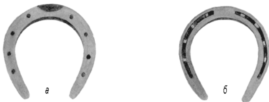
Рисунок 7. Подкова: а – верхняя поверхность; б – нижняя поверхность.
