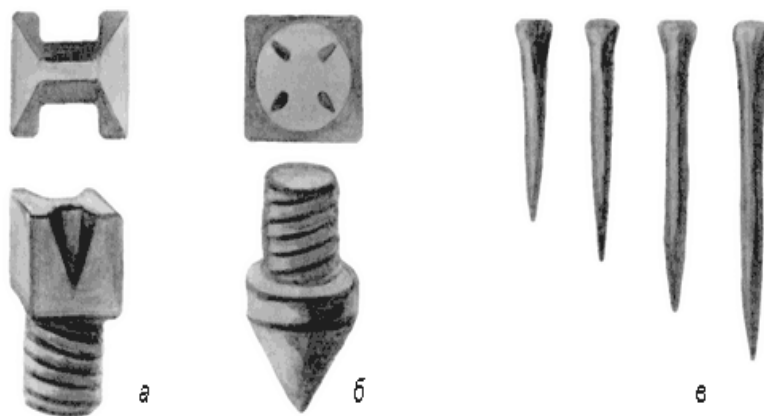
Рисунок 8. Материалы для ковки лошади: а – винтовой съемный Н-образный шип; б – винтовой съемный конусообразный шип; в – подковные гвозди.
