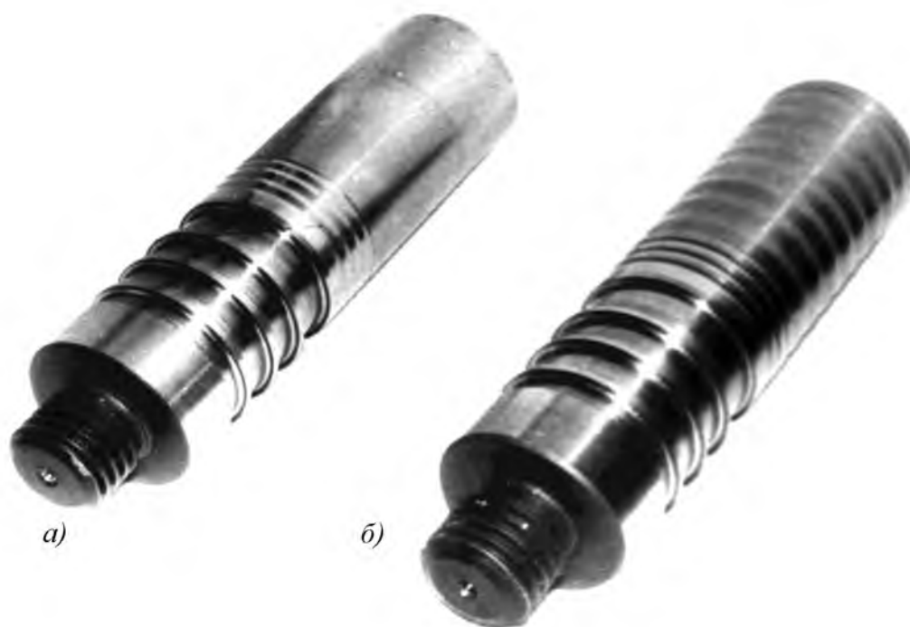
Рисунок 4 – Вид координатных протяжек с удлиненными задними направлениями:
