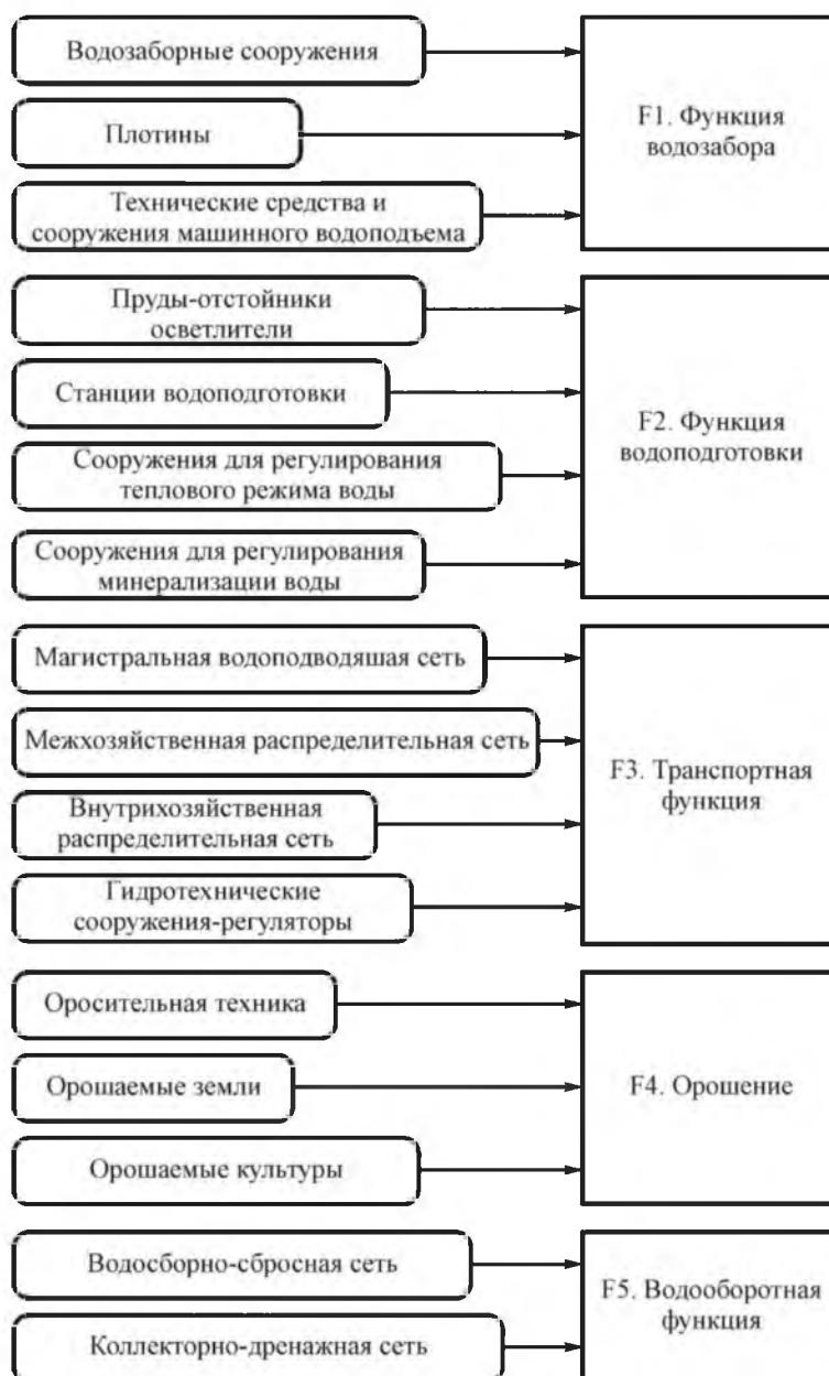
Рисунок 1 – Компонентно-функциональная модель оросительной гидромелиоративной системы. Технологическая функция
