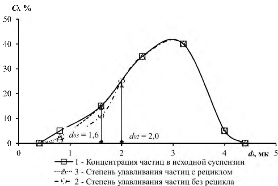
Рисунок 3 – Плотность распределения частиц дисперсной фазы в отработанном моторном масле в исходном состоянии (1), при однослойном (2) и двухслойном течении жидкости в сверхцентрифуге с рециклом по фугату re = 1 (3)
