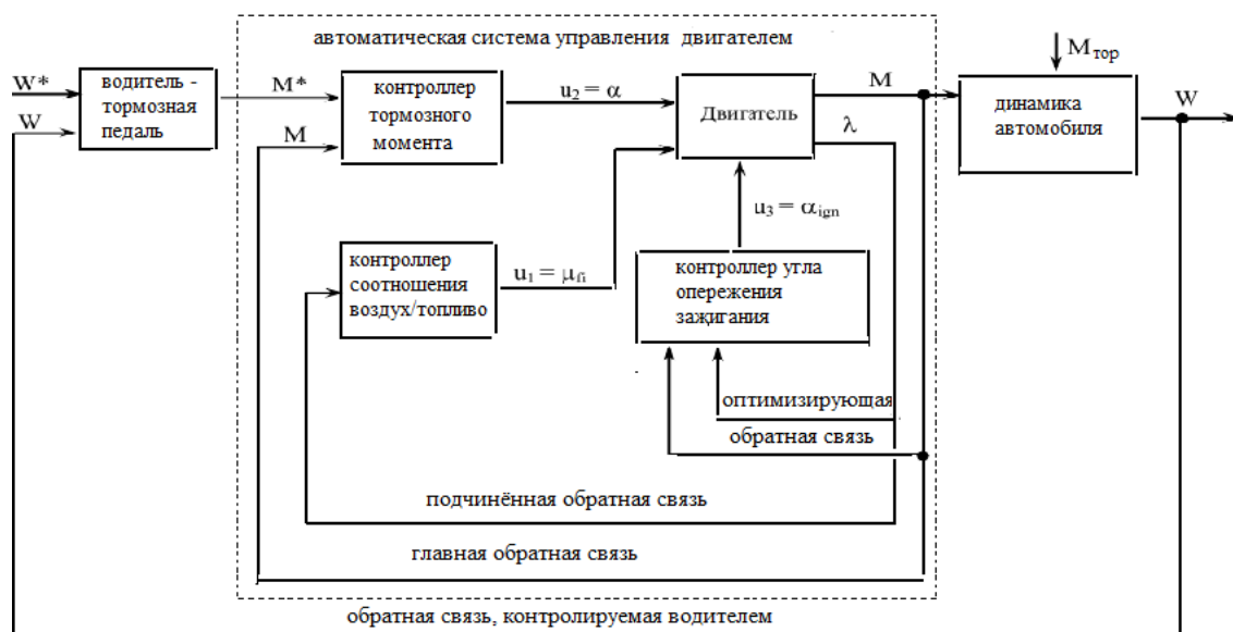
Рисунок 5 – Схема автоматизированной системы управления двигателем внутреннего сгорания при его использовании в качестве тормоза
