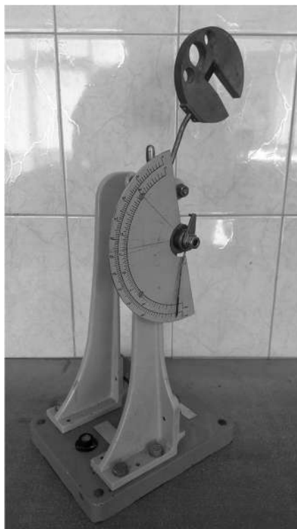
Рисунок 2 – Маятниковый копер для динамических испытаний
