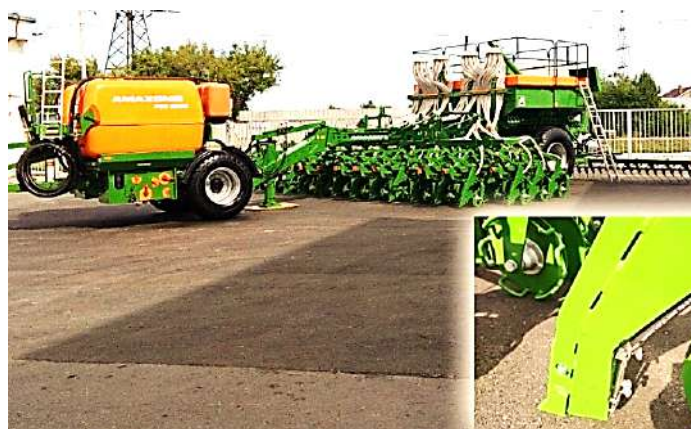
Рисунок 6 - Агрегатирование FDC-6000: а)-с пропашной сеялкой EDX 9000-TC и зерновыми-Primera DMC 9000/12000, Condor 12000/15000; б)-сошник сеялки Primera DMC с продуктопроводом для карбамидно-аммиачной смеси-КАС
