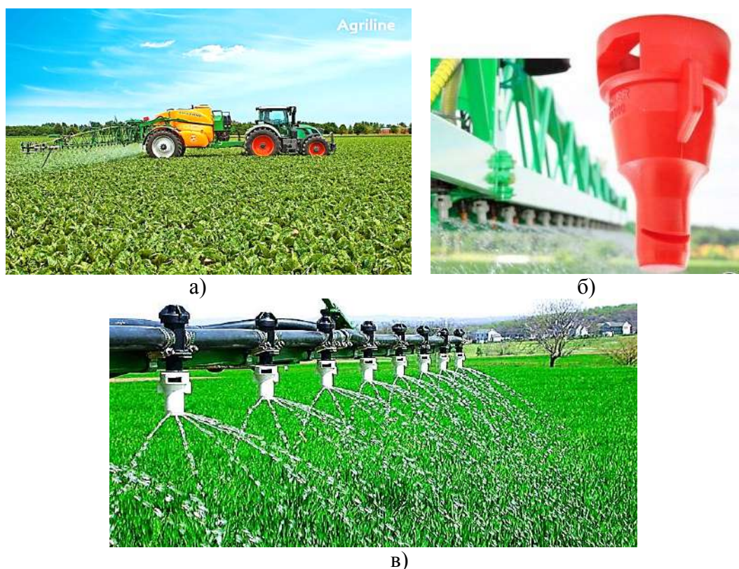
Рисунок 1 – Опрыскиватель АО «Евротехника» для КАС-а); обработка посевов дефлекторными форсунками-б); работа крупнокапельных пятиструйных форсунок-в)
