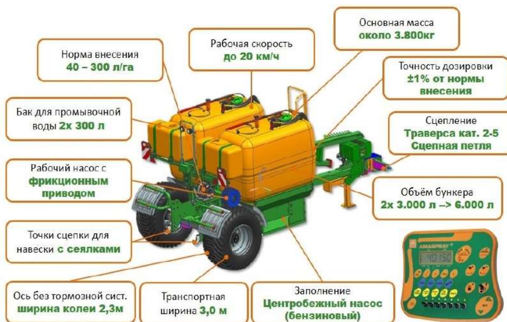
Рисунок 5 – Агрегат FDC-6000 с основными рабочими узлами
