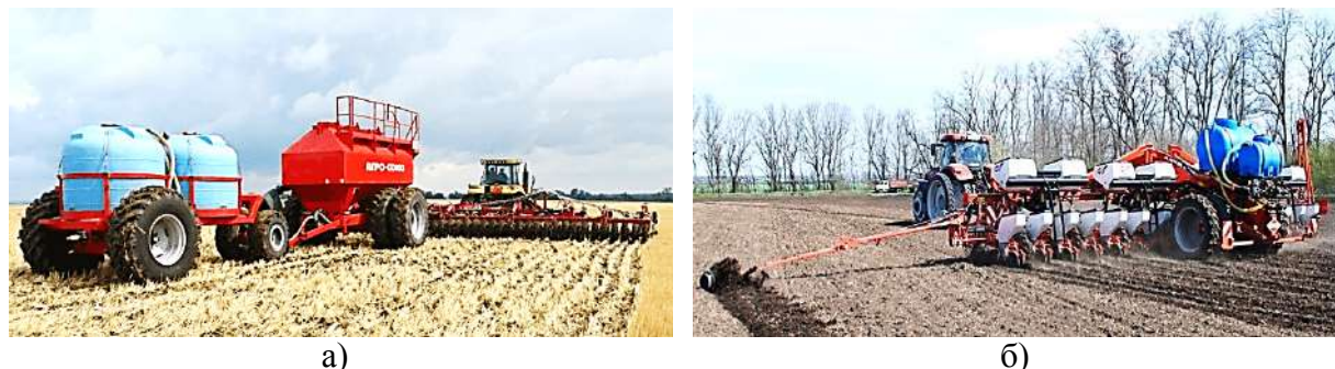
Рисунок 4 – Комбинированные агрегаты-сеялки для посева зерновых и пропашных культур с одновременным внесением жидких и твердых минеральных удобрений:
