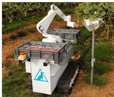
Рисунок 2 – Робот для сбора ягод Figure 2 - Robot for collecting berries
