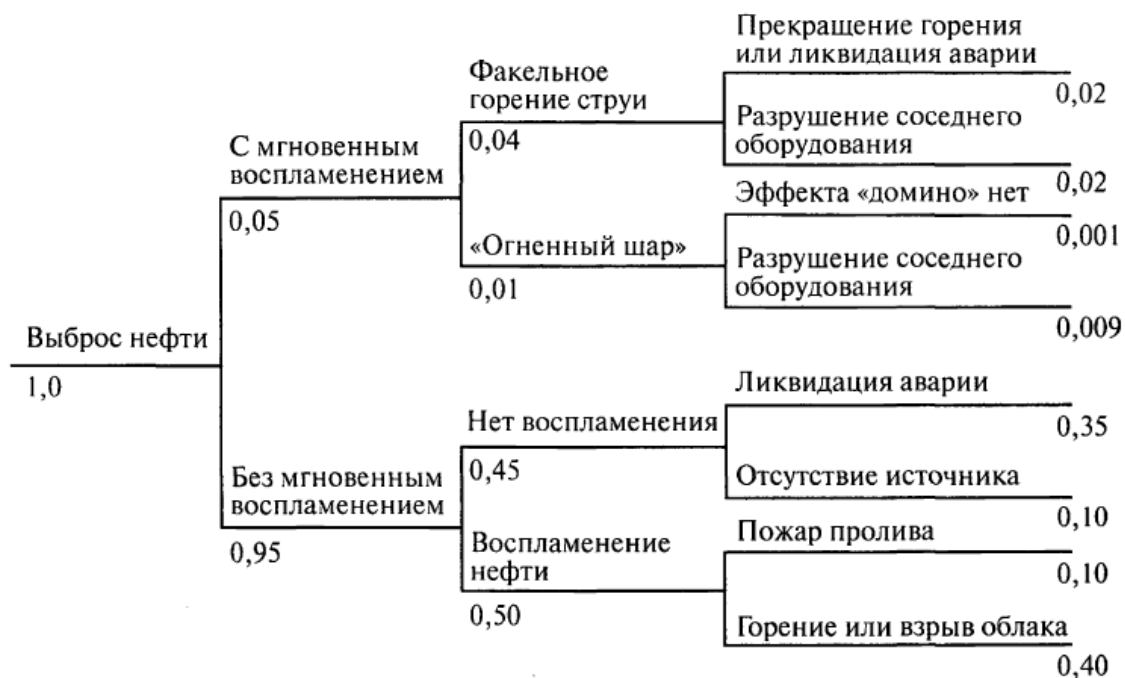
Рисунок 1 – Дерево событий аварий на установке первичной переработки нефти
